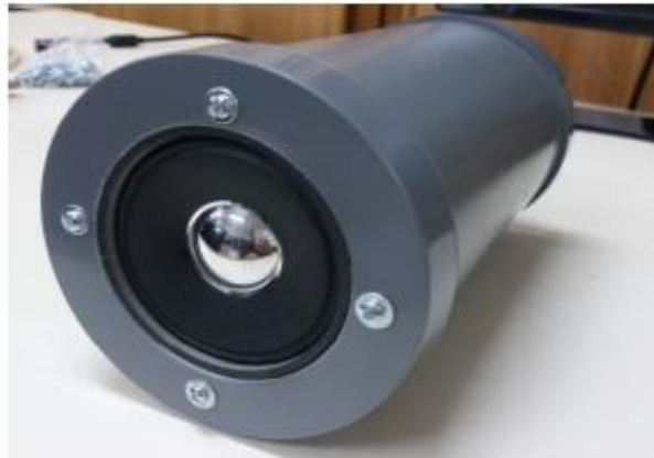
Figura 3.1-3 Fotografía del parlante fabricado para el experimento de localización de audio.
