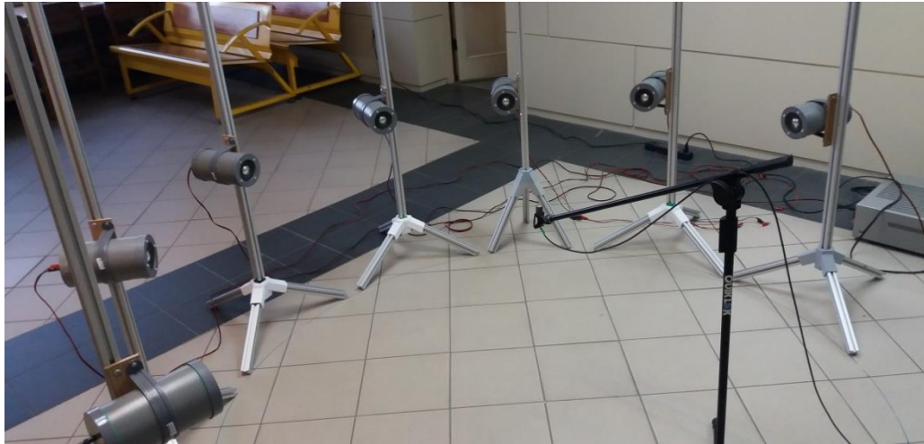
Figura 3.1-4 Pilar compuesto por columna, patas, pieza de unión, soporte para parlante.
