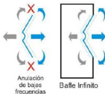
Figura 3.1-1 Ilustración del funcionamiento de la caja acústica [33].
