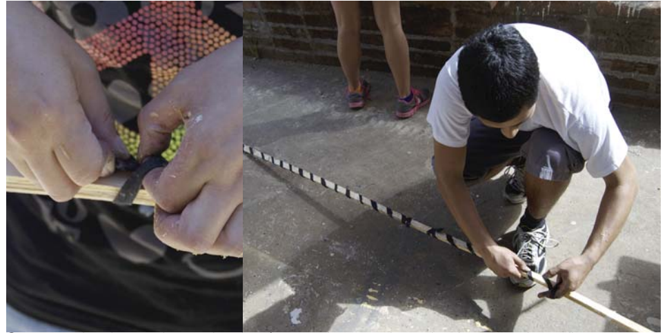
Se cortan tiras largas de caucho de cámaras de 1 cm de ancho. Luego se les aplica cera para evitar que se pegue a la tulipa por el exceso de colafria. Siempre se parte amarrando desde el centro hacia el exterior de las tulipas.
