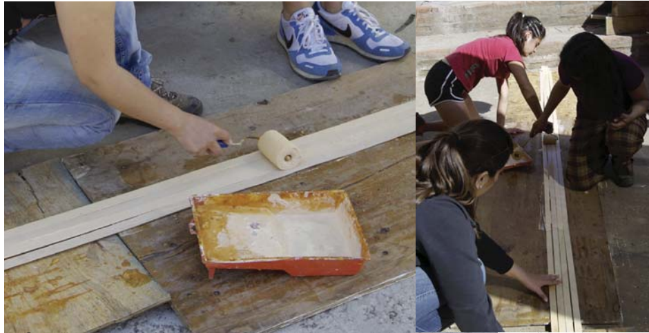
Se utiliza una colafria catalizada, muy resistente a la humedad. Este se aplica sobre las tulipas con un rodillo, dejándolo cubierto de pegamento.
