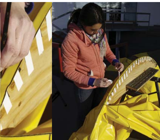
El exceso de pegamento debilita la tela, por lo que se debe controlar la cantidad esparcida.
