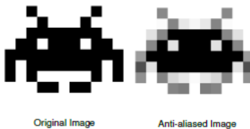
Ilustración 4-9 Ejemplo de Antialiasing ; Error! No se encuentra el origen de la referencia..
