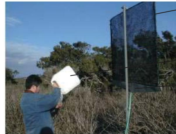
a. Neblinómetro y el proceso de medición de agua captada.
