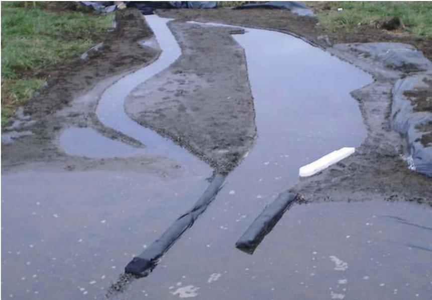
En la imagen se puede apreciar que el área norte del puerto se comienza a inundar al aumentar el caudal y luego al abrir el otro cause baja el nivel
