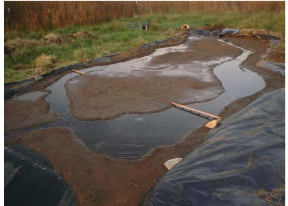
Modelo del río aconcagua en su configuración normal escala 1:250,realizado en la vega de ciudad abierta.
