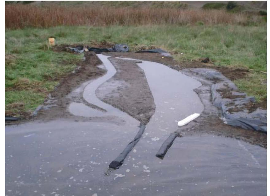
Modelado de el canal portuario con dos molos que le configuran una boca protegida del surweste y el norte que protege de los sedimentos arrojados por el rio a el puerto
