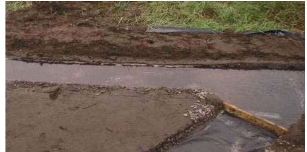
el brazo norte con la compuerta cerrada logra evacuar el caudal de la prueba
