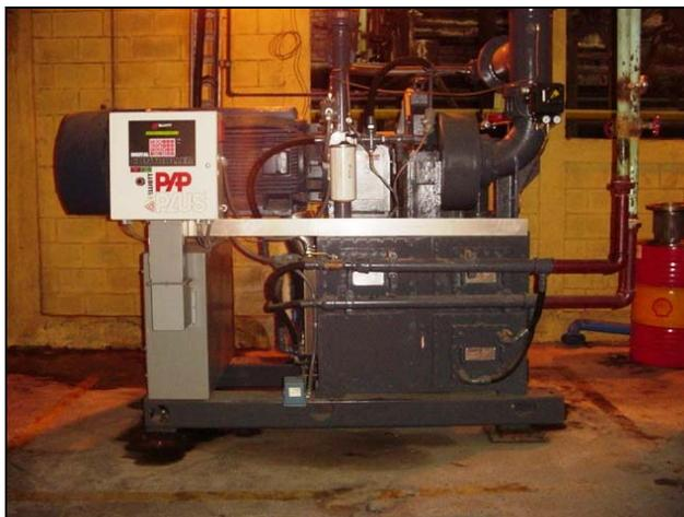
**Figura 2.23** Compresor de Nitrógeno C.05/C.010
