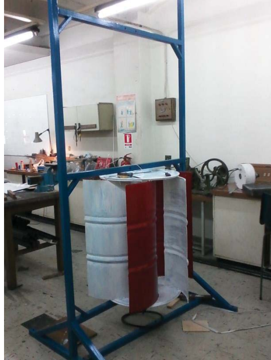
Figura 2-22: Construcción de la estructura y turbinas
