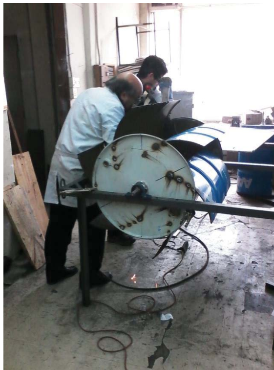
Figura 2-21: Labores en la construcción de las turbinas
