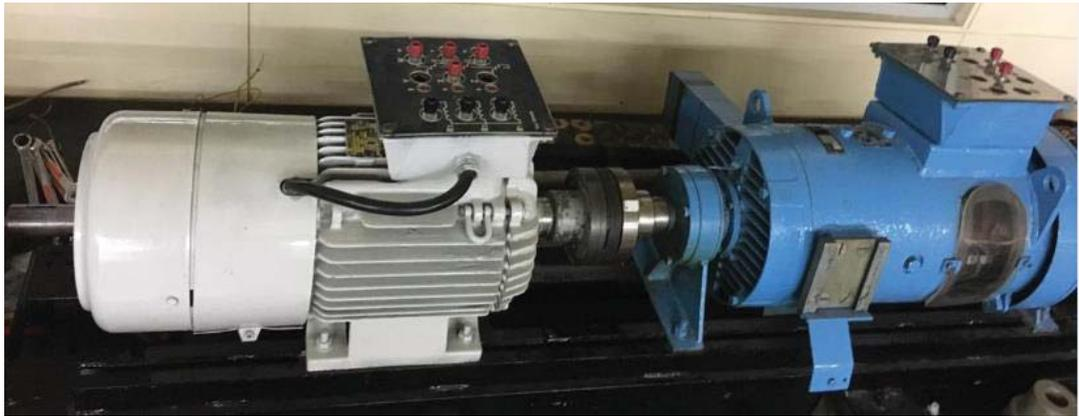
Figura 3-1.1: Motor de inducción trifásico acoplado con un generador de corriente continua.
