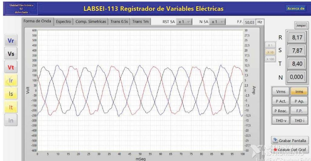
Figura 3-2.3: Formas de onda de corriente y valor RMS en el estator.
