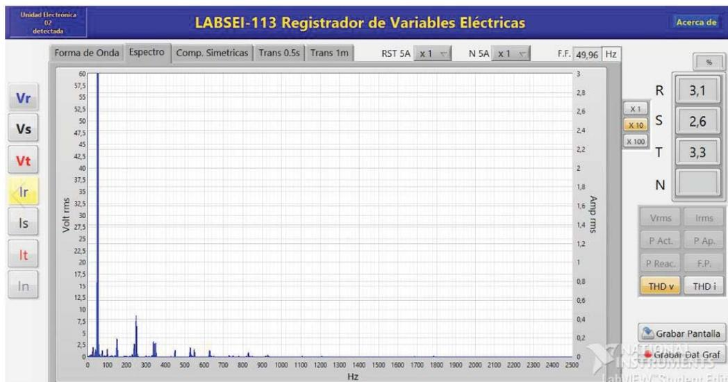
Figura 3-2.4: Espectro de onda de corriente fase R y THD(v) en las fases R, S y T.
