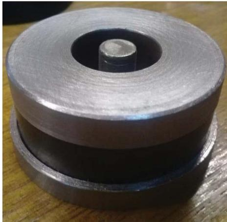
Figura 5-2 Actuador electromecánico construido.
