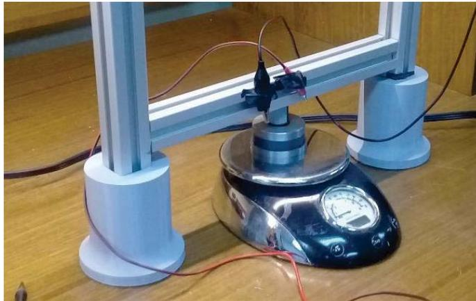
Figura 5-10 Prueba realizada con el actuador electromecánico.
