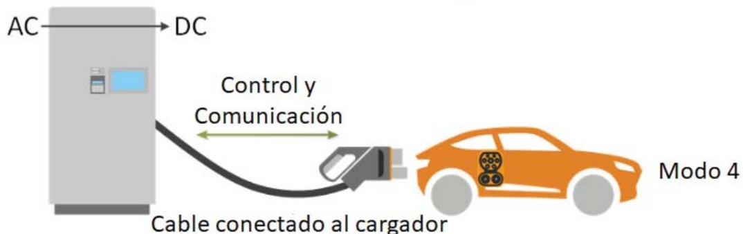
Figura 2-10: Modo 4 de carga de vehículos eléctricos [25].
