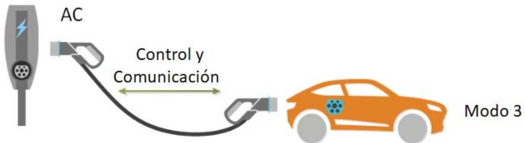
Figura 2-9: Modo 3 de carga de vehículos eléctricos [25].
