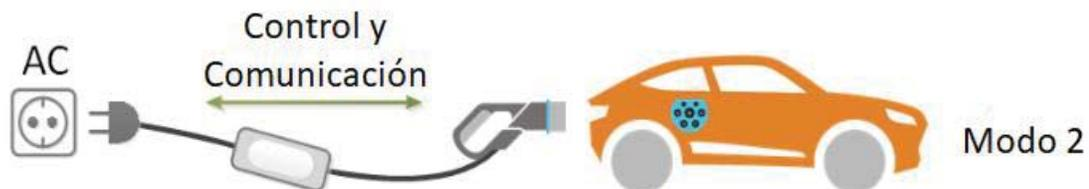
Figura 2-8: Modo 2 de carga de vehículos eléctricos [25].
