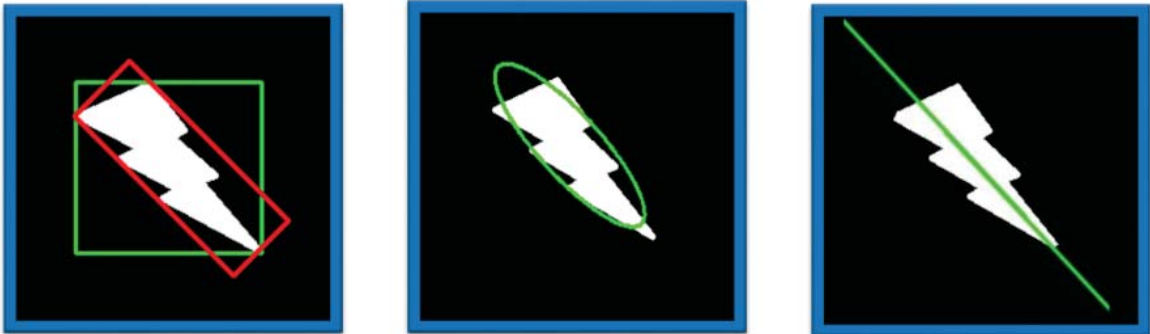
Figura 4-4: Ejemplo de técnicas de cálculo de orientación de un objeto (fuente: http://docs.opencv.org ).
