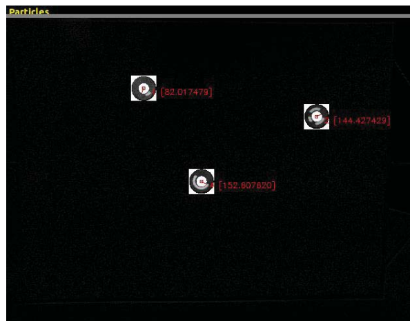
Figura 3-3: Detección de tres robots con aplicación SwisTrack.
