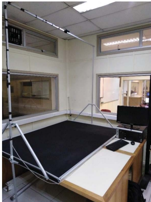
Figura 3-10: Plataforma de prueba con el computador con cámara y computador para controlar robots.
