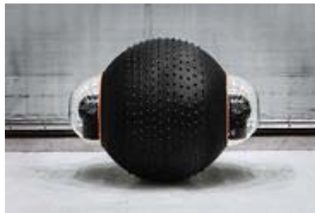
Figura 1-7: Robot de Vigilancia Rotundus.
