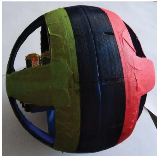
Figura 3-12: Robot esférico negro con cinta de color rojo y verde para su reconocimiento en software Swistrack.
