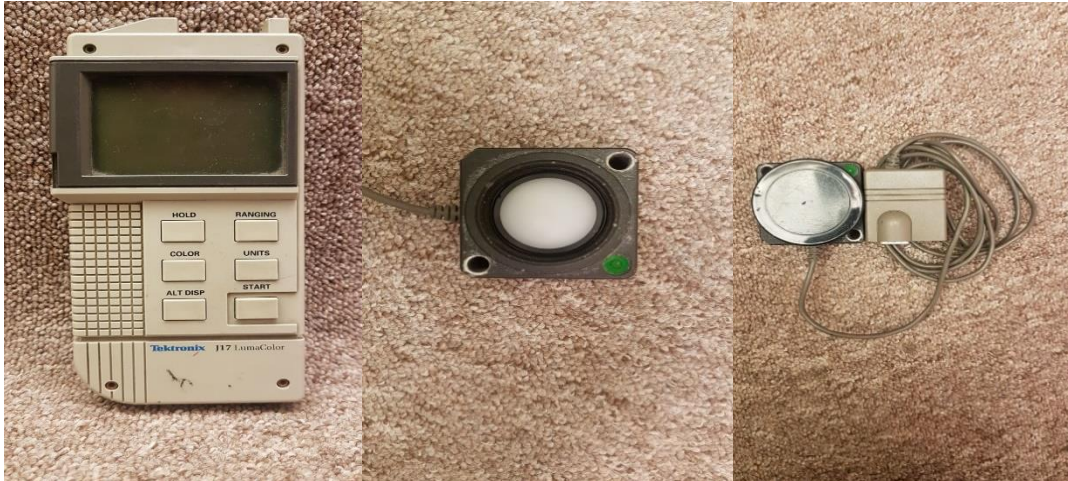
Figura 4-2: Luxómetro Tektronix J17 LumaColor utilizado en las mediciones (Fuente: Laboratorio de Fotometría y Control de Calidad PUCV)
