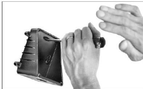
Figura 3-27: Perforaciones de la caja.
