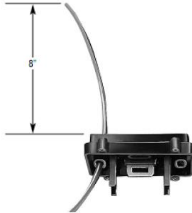
Figura 3-24: Cable insertado en la base de la caja.
