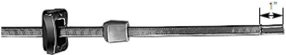
Figura 3-16: Corte de forro exterior.
