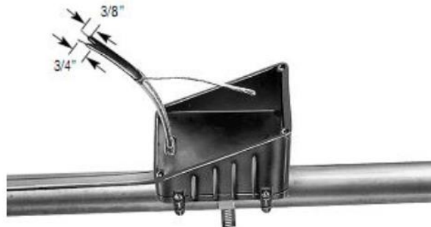
Figura 3-30: Corte de punta de cable.
