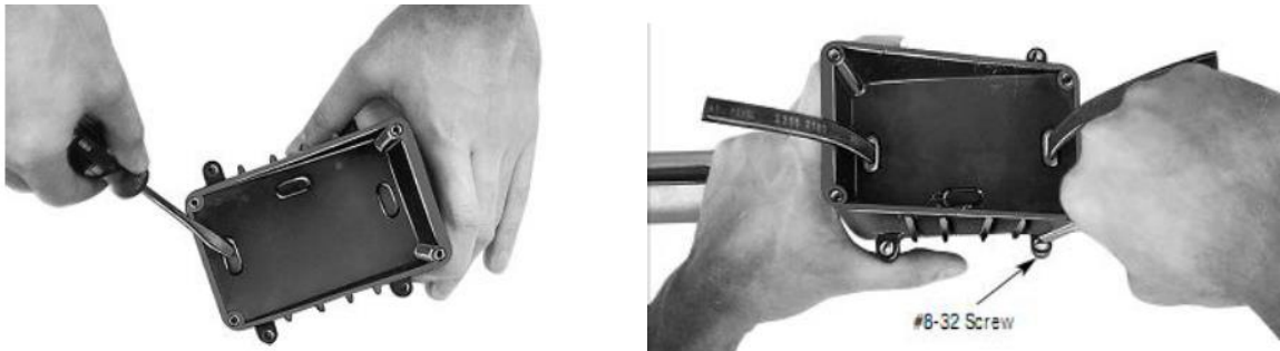
Figura 3-40: Perforaciones para pasar cable y montaje de base de la caja.
