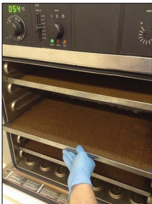
Figura 14: Bandejas de alimento dispuestos en la estufa "Memmert", modelo "Um-200".
