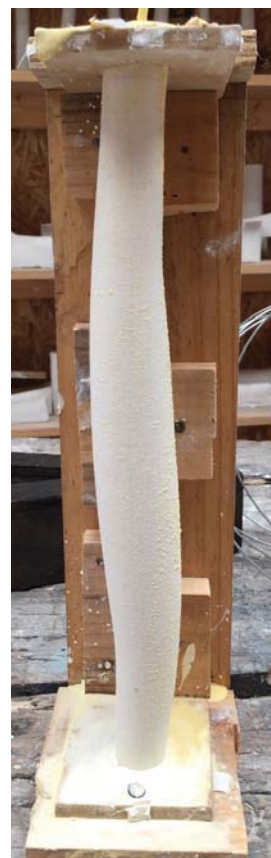
Moldaje en proceso de secado
