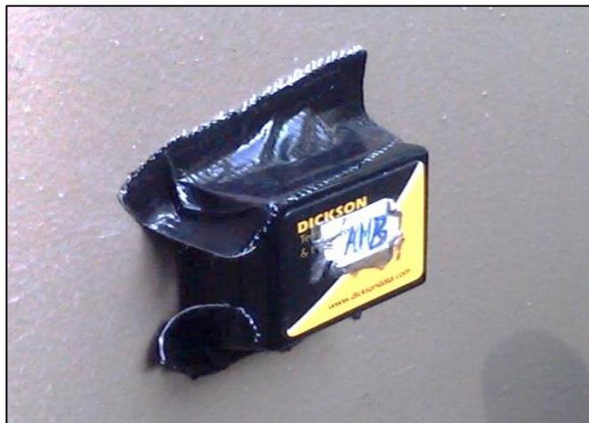
Fig. 3.4: Data logger, programado para registrar la temperatura.
