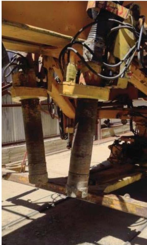
*Fig. 46 Ductos de aspiración del balasto contaminado “Plasser&Theurer – VM 250 S Jumbo”. Febrero de 2014.*
