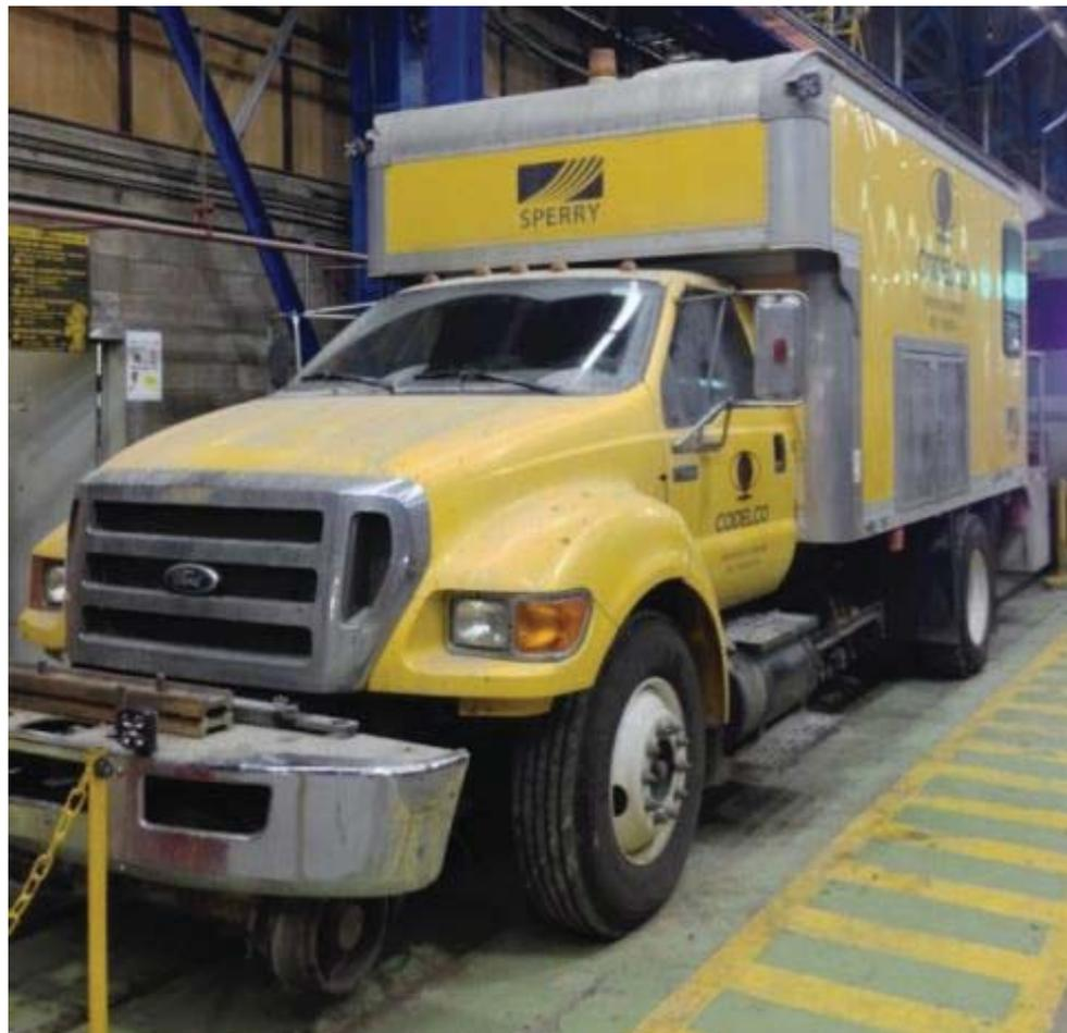
*Fig. 47 Mantenimiento de vehículo ultrasonido de inspección vía “Sperry - 950 Series” en línea #11 Maestranza 1, Colón Alto. Mayo de 2014.*
