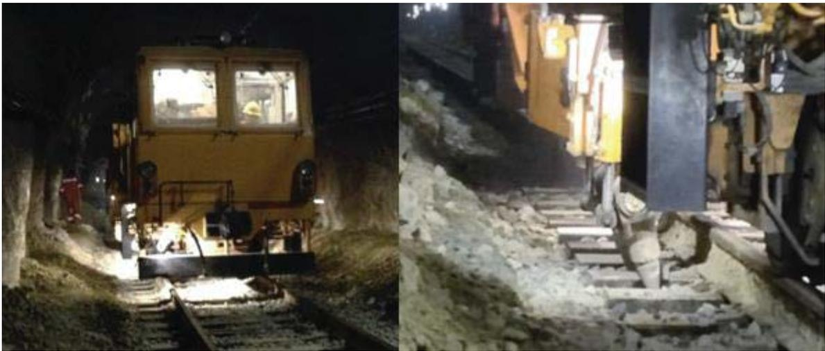
*Fig. 44 Mantenimiento de compactación de balasto en línea de producción, Mina El Teniente. Febrero de 2014.*
