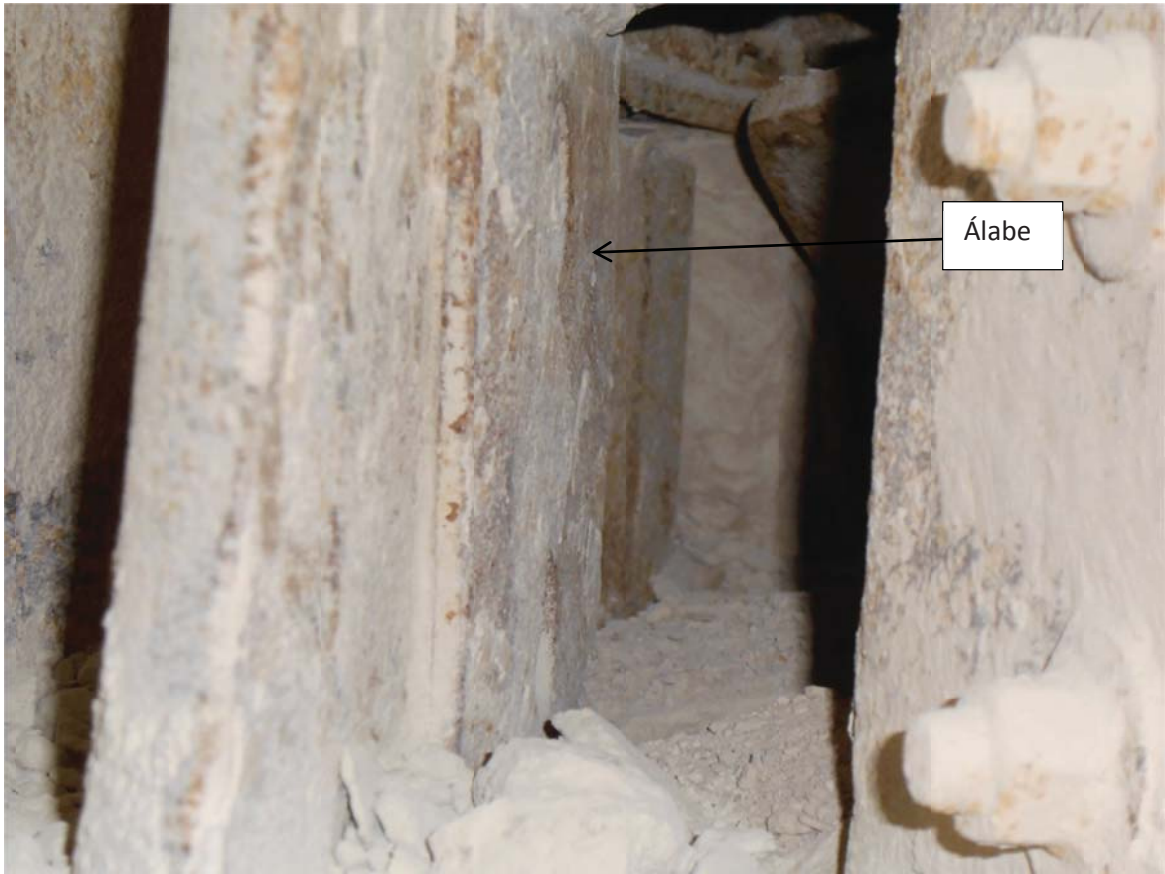
Fig. 10: Fotografía de los alabes fijados a la base del molino.
