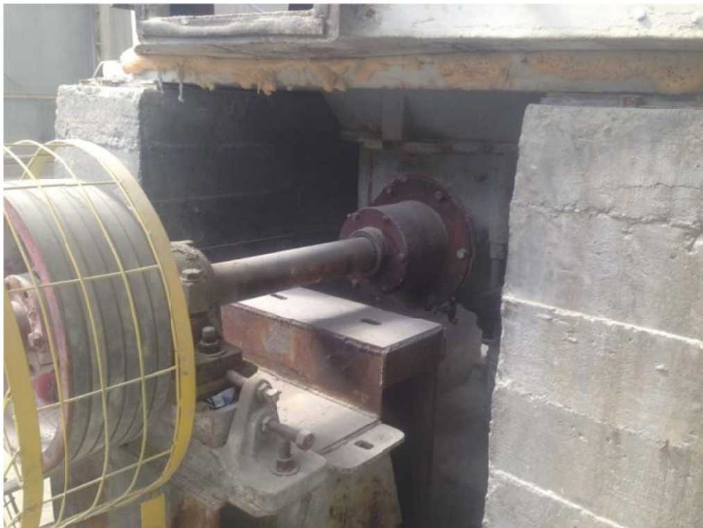
Fig. 15: Fotografía del eje horizontal, soporte de rodamiento, polea y cárter.
