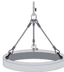
Fig. 27: Representación como ubicar las eslingas.
