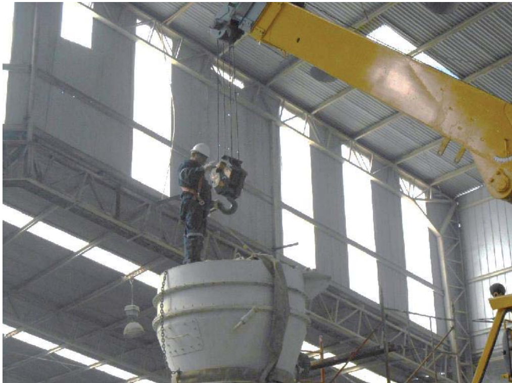
Fig. 101: Ubicando gancho de la grúa.
