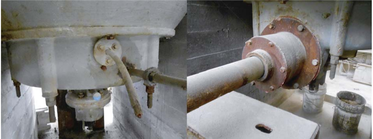
Fig. 13: Cáster con líneas de lubricación.
