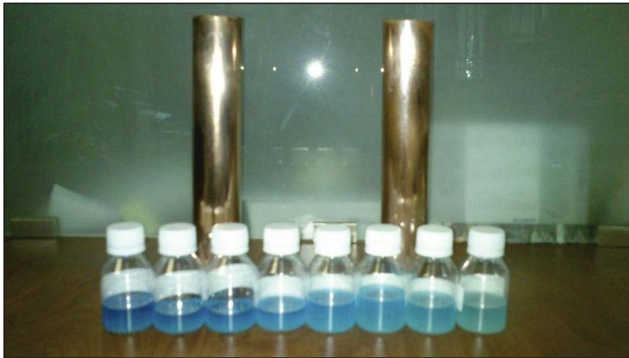
Figura 4.2: Muestras de electrolito y cátodos obtenidos Experiencia 2
