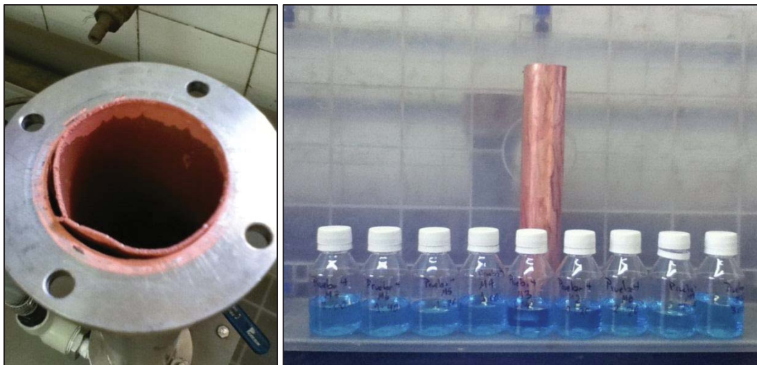
Figuras 3.4 y 3.5: Celda desmontada mostrando camisa y cátodo en su interior y muestras de electrolito con su cátodo obtenido
