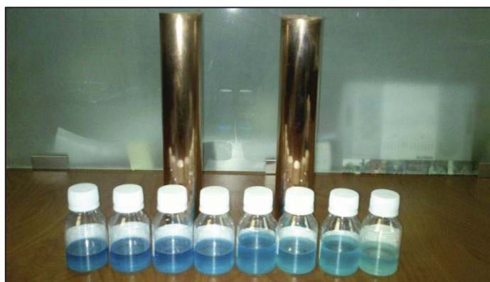
Figura 4.5: Muestras de electrolito y cátodos obtenidos Experiencia 3
