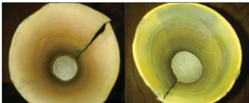
Figuras 4.6 y 4.7: Interior cátodos Prueba 3.1 y Prueba 3.2
