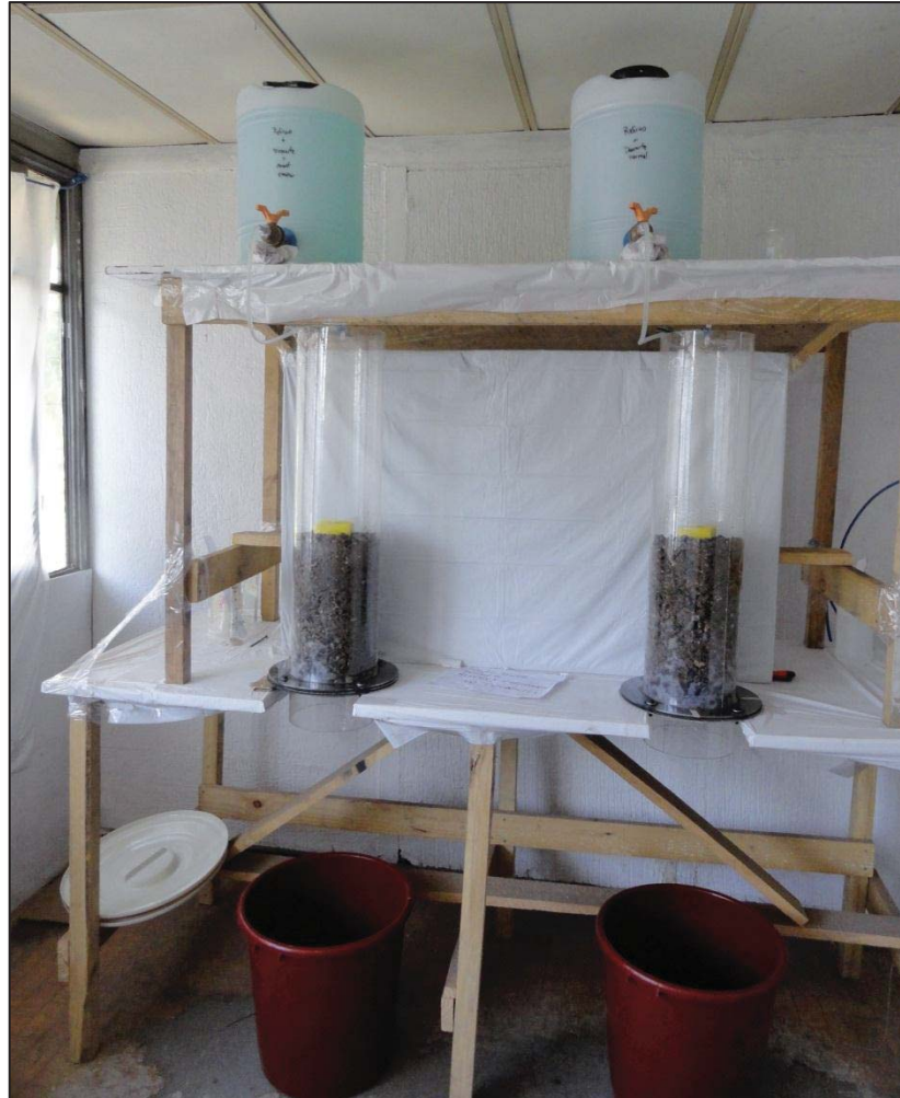
Figura 4.9: Columnas de Lixiviación instaladas
