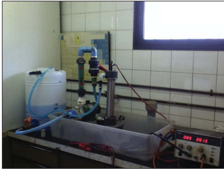
Figura 3.3: Celda EMEW® de laboratorio ensamblada y conectada
