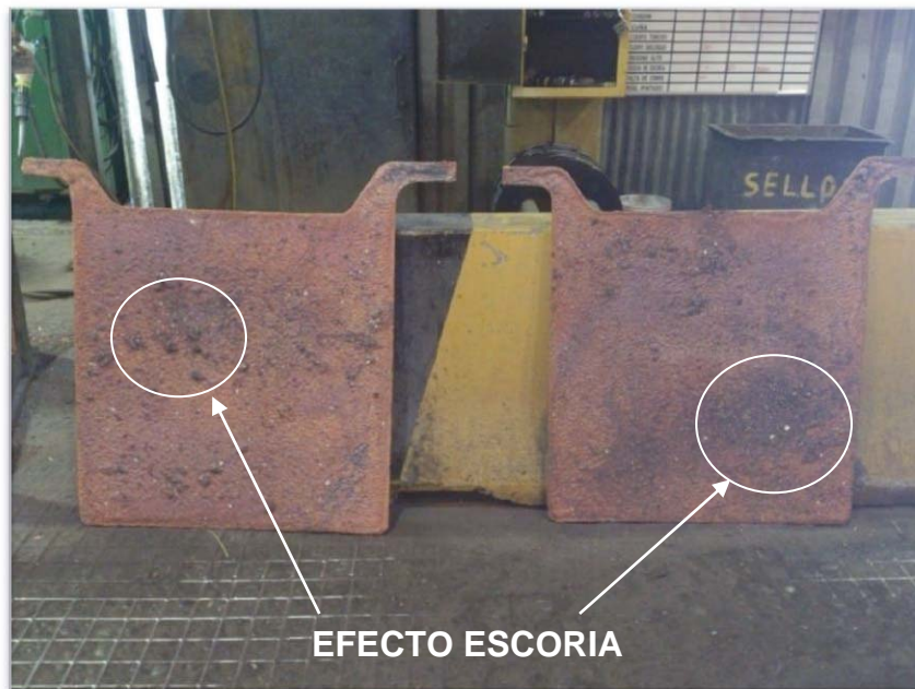
Figura 3.6 Efecto de Exceso de Escoria en Ánodos Ventana
