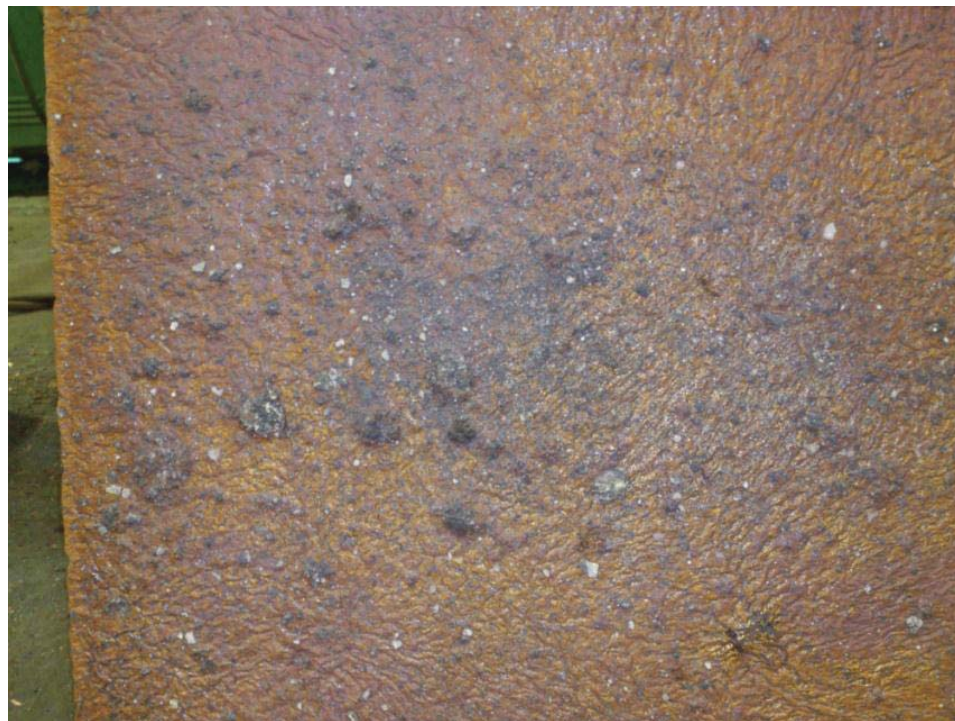
Figura 3.21 Ánodo con Exceso de Escoria
