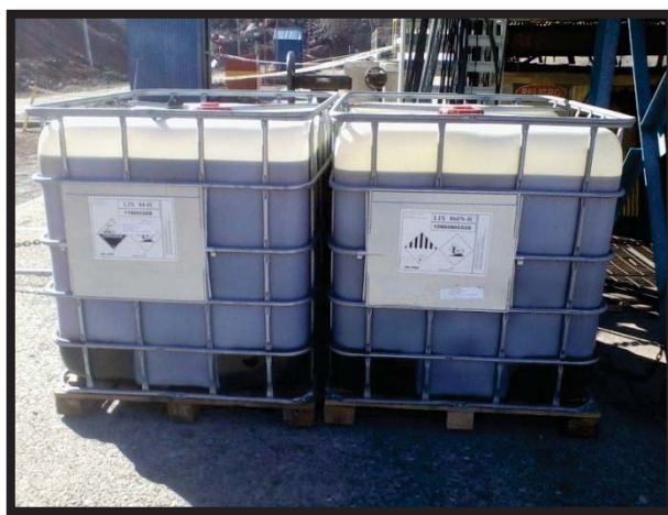
Figura 3.7: Tote Bins de reactivos extractantes (1 Ton de capacidad cada uno)
