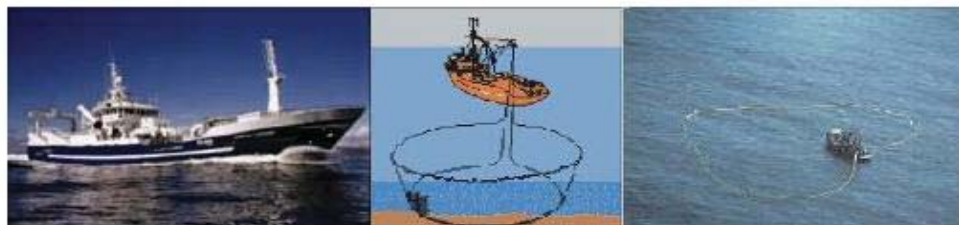
Figura 1: Embarcación tipo dedicada a la explotación y sistema de recolección (cerco) Fuente: Fondo de investigación pesquera (FIP)
