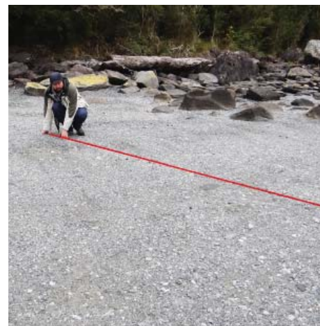
Figura 27. Medición ángulo playa. Paso 1, persona sujeta un extremo del cabo a nivel de playa.
