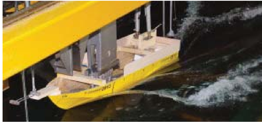
Figura 71. Ensayos de modelos en canal de prueba de la Universidad Politécnica de Madrid, Escuela de Ingenieros navales. Fuente: www.etsin.upm.es/ETSINavales
