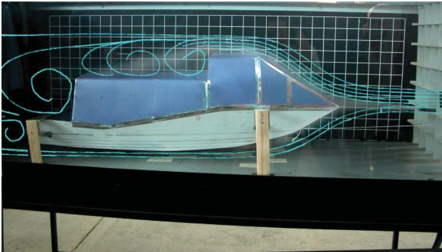
Figura 19. Modelo en túnel de viento. Observación flujo laminar y turbulento.Fuente: L.Krebs, 2011
