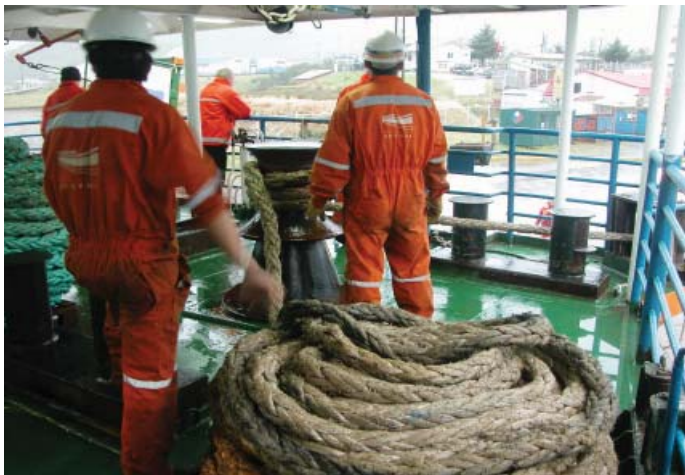
Figura 49. Tanto las bitas, los cabos y los huinches son imprescindibles para la maniobra de llegada a la orilla. Son estas las que orientan a la embarcación a la llegada a la rampa-orilla. fuente: L.Krebs
