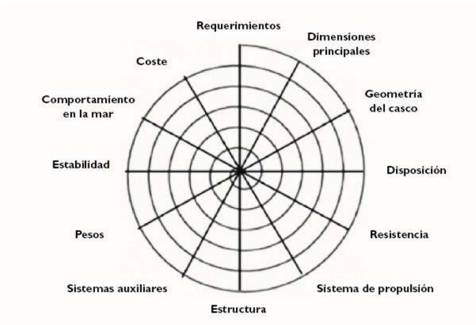
Figura 1. Espiral de diseño de buque. Fuente: Clase de magíster Introducción a Sistemas Marítimos del profesor S.Ostornol
