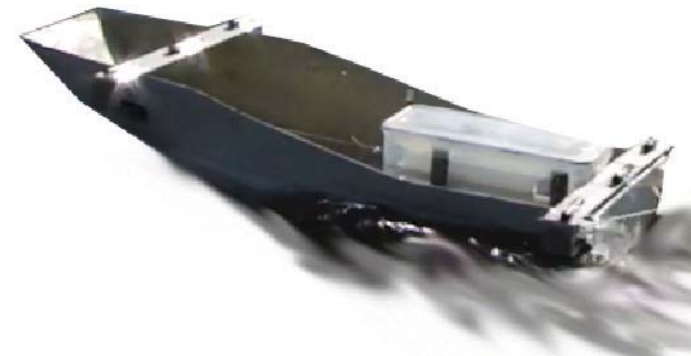
Figura 2. Pruebas de modelo escala 1:12 con perfiles hidrodinámicos y sin perfiles, con y sin superestructura. Fuente: L.Krebs
