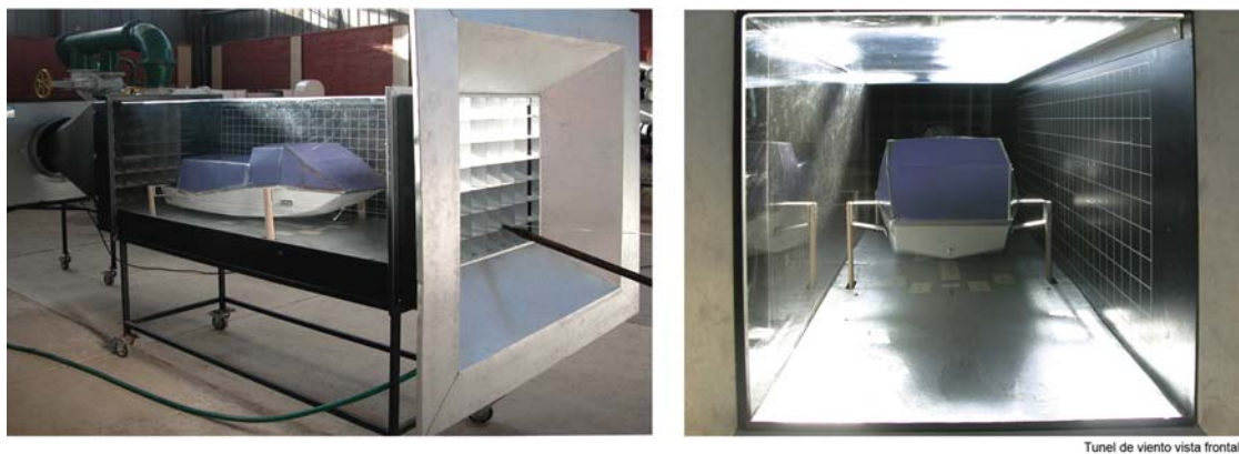
Figura 7. Túnel de viento con modelo embarcación hidrofoil en su interior. Fuente: L.Krebs, 2011
