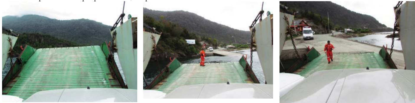
Figura 15. Secuencia de apertura de rampa de acceso. Fuente: N.Moraga, Travesía 2011.
