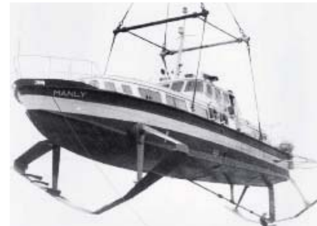
Figura 23. Hydrofoil Manly, primer ferry de pasajeros que operó en Sydney, 1965 a 1980. Eslora 18,3 m, manga 5,85 m, velocidad 34 kn, 72 pasajeros. Fuente: www.wikipedia.org/wiki/MV_Manly_(1965)
