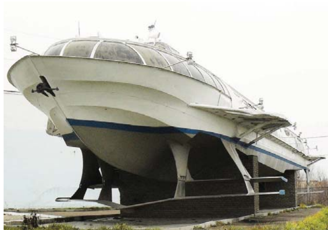
Figura 21. Hydrofoil ruso de pasajeros, clase Meteor. Diseñado por Rostislav Alexeyev, se fabricaron desde 1961 a 1991 y fueron usados en Vietnam, Grecia, Italia, China, Rusia, Usa, Croacia, entre otros. Fuente: www.wikipedia.org/wiki/Hydrofoil
