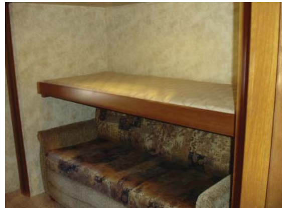
Figura 76. Cama sobre sillón. Esta cama al no ser utilizada se encuentra adosada a la pared en forma vertical y cuando debe ser utilizada esta se abre hasta la posición horizontal.
