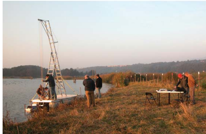
Figura 3. Estero Mantagua, Ritoque, Ciudad Abierta. Estructura flotante con sistema de contrapesos y mesa con computador que registra inalámbricamente la velocidad y la resistencia del modelo. Fuente: L.Krebs..
