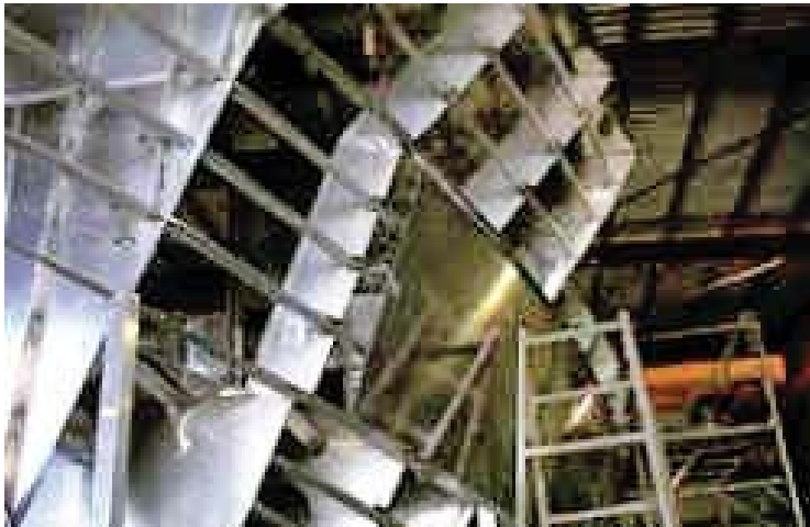
Figura 112. Esqueleto casco de aluminio. Fuente: http://www.fondear.org/infonautic/barco/Diseno_Construccion/Ventajas_Aluminio/Ventajas_aluminio.htm
