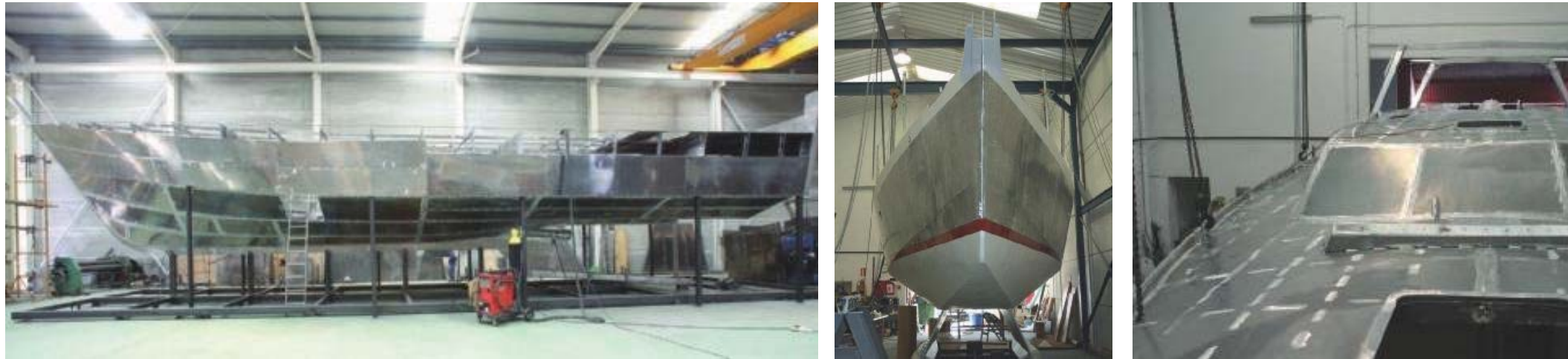
Figura 108. Imágenes de casco de aluminio en construcción. Fuente: http://www.fondear.org/infonautic/barco/Diseno_Construccion/Ventajas_Aluminio/Ventajas_aluminio.htm
