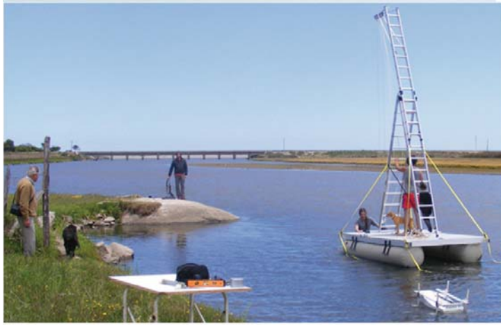
Figura 3. Estero Mantagua, Ritoque, Ciudad Abierta. Estructura flotante con sistema de contrapesos y mesa con computador que registra inalámbricamente la velocidad y la resistencia del modelo. Fuente: L.Krebs..
