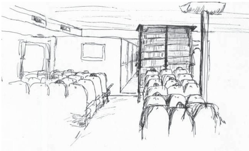
Figura 41. Salón principal de pasajeros, equipada con asientos tipo butacas de bus (250) orientados hacia proa separados por dos pasillos principales. Fuente: L.Krebs
