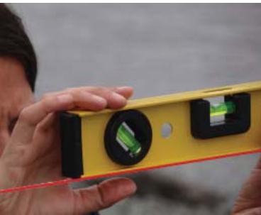
Figura 23. Nivelación de burbuja sobre línea del cabo .
