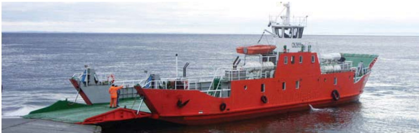
Figura 14. Barcaza sin proa ni popa, se abren las rampas en cada extremo de la embarcación.
