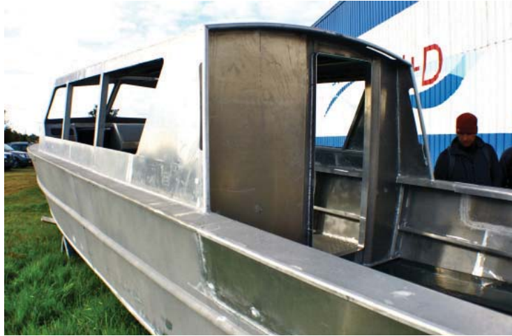
Figura 119. Lancha de aluminio en construcción en empresa Sitecna S.A. Fuente: elaboración propia de autor.
