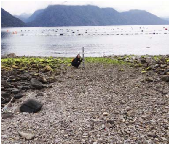
Figura 21. Mediciones realizadas en isla Llancahue para obtener la pendiente de la playa. Fuente: L.Krebs, travesía 2011
