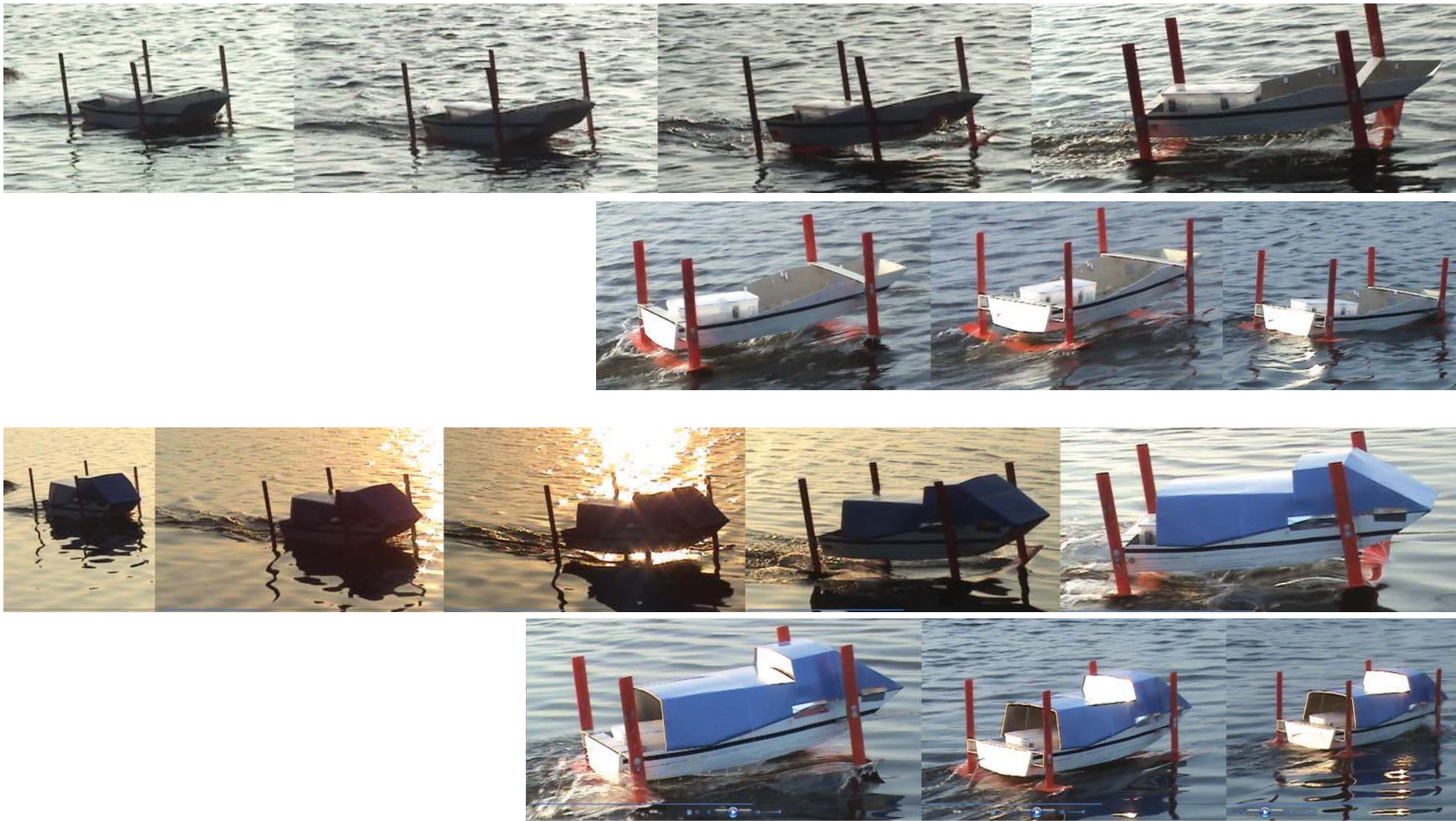
Figura 6. Secuencia de imágenes de una de las pruebas de modelo en canal de arrastre con y sin carcasa o superestructura. Fuente: L.Krebs, 20011
