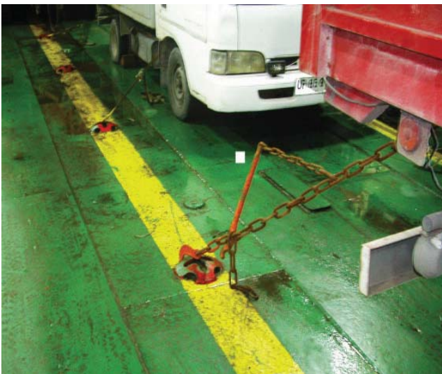
Figura 50. Sistema de anclaje de los vehículos al suelo de la embarcación. son objetos metálicos soldados al suelo. Fuente: L.Krebs
