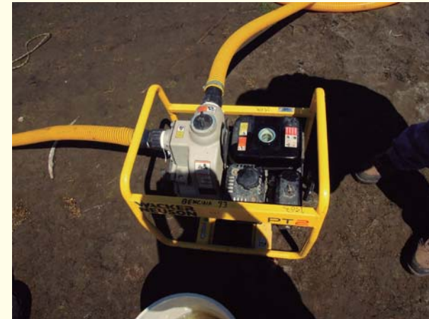
Conexiones de manguera de salida y entrada de la bomba hidráulica
