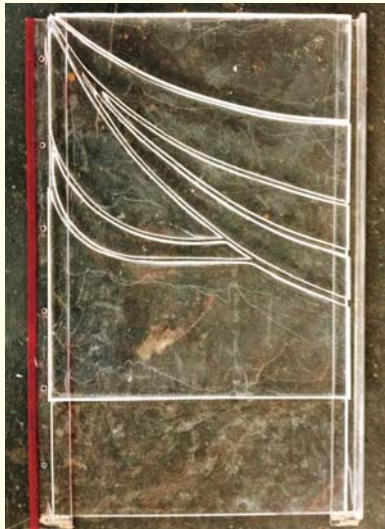
3. Corte con olfa 800 acrílico 4mm matriz 2
