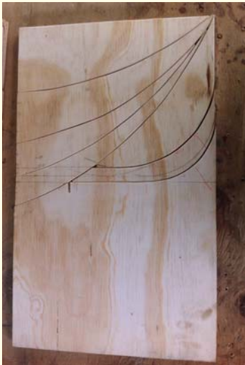
1. Corte con caladora terciado 15mm matriz 1
