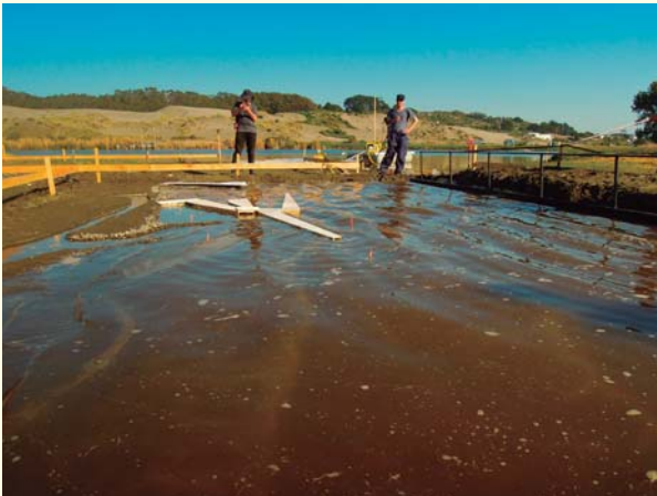
Generación de oleaje distintas frecuencia y alturas con paleta de olas
