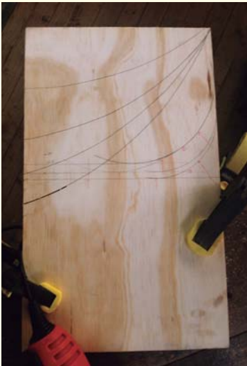
1. Corte con caladora terciado 15mm matriz 1
