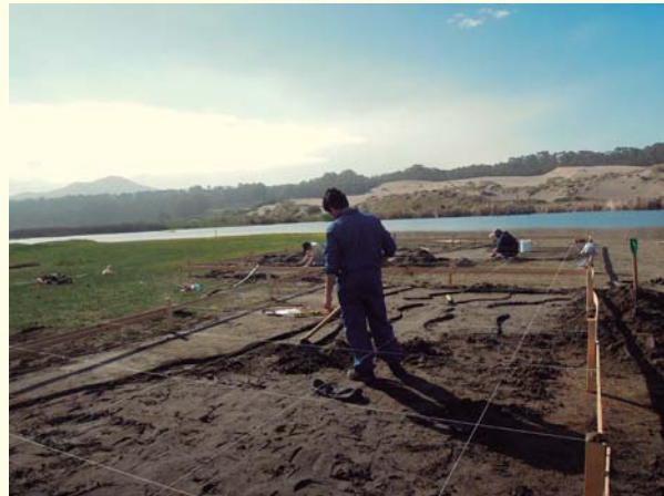
Modelado de curvas de nivel y batimetría
