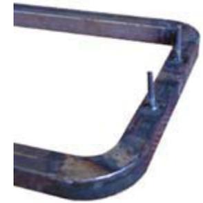
sopORTE Se utilizaron perfiles cuadrados de 30x30mm y 1,5mm de espesor. La pieza en su totalidad es el soporte de la rueda y además es soporte de las piezas de hormigón correspondientes al posa latas y al posa PET. Estas piezas van fijadas, una en cada "brazo" de la figura en "Y" que forma el soporte.
