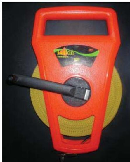
Figura 3-1 Cinta Métrica Topográfica [2]
