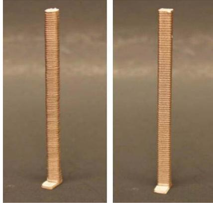
Figura 1-19: Torre 500 capas de 0.2 [mm] (izquierda) y de 200 capas de 0.5 [mm] (derecha).
