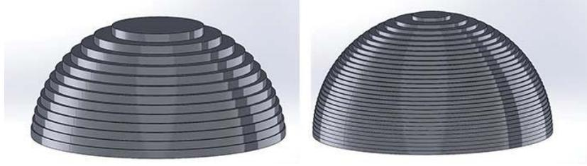
Figura 2-1: Diferencia altura de capa (fuente: <http://www.creatu3d.com>)
