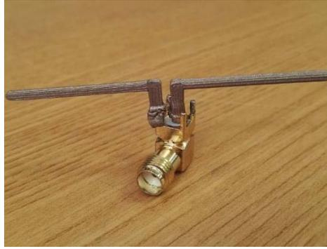
Figura 3-23: Dipolo impreso con Electrifi y montado en conector SMA.
