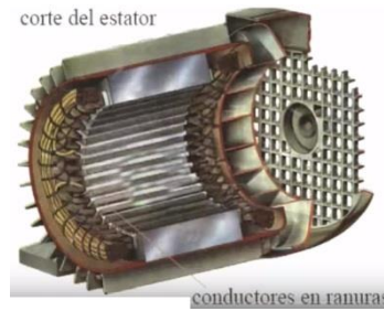
Figura 2-1: Estator de un motor eléctrico (fuente: http://apuntescientificos.org )
