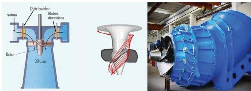
Figura 3-6: Turbina hidráulica Kaplan (fuente: <http://www.areatecnologia.com>)
