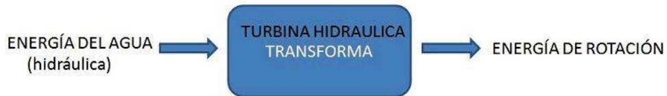
Figura 3-1: Funcionamiento de una turbina hidráulica (fuente: <http://www.areatecnologia.com>)
