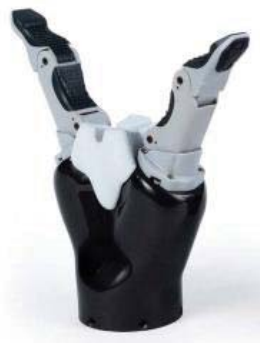
Figura 1-11: Pinzas de agarre Kinova KG-2 [24]
