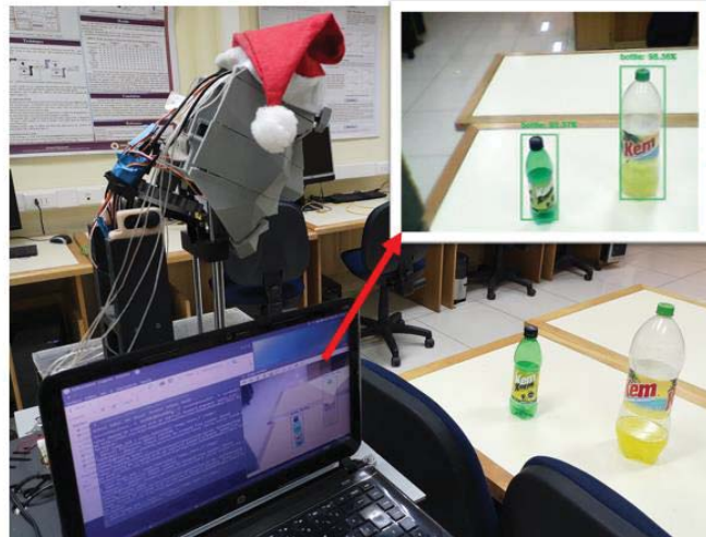
Figura 4-14: Robot “CJ” visualizando y reconociendo dos objetos de interés
