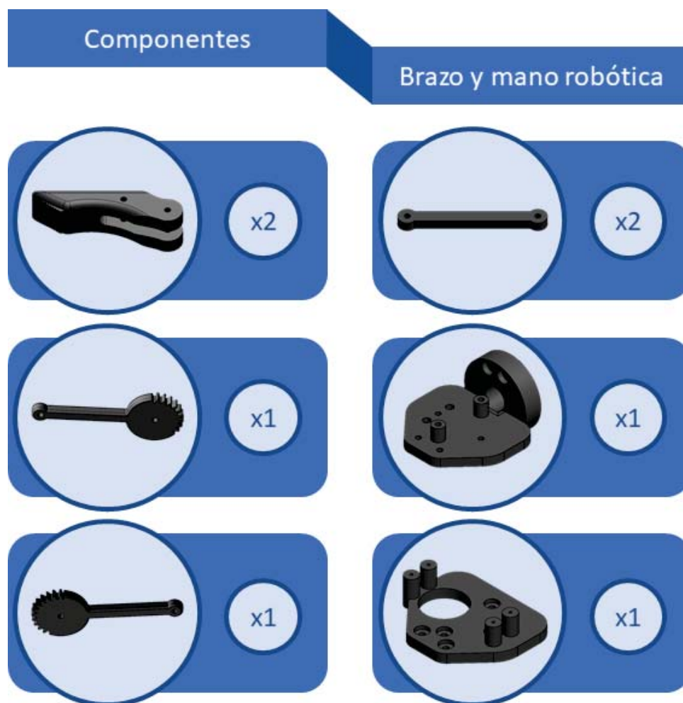
Figura C-1: Componentes de la mano de brazo robótico para manipulación de objetos
