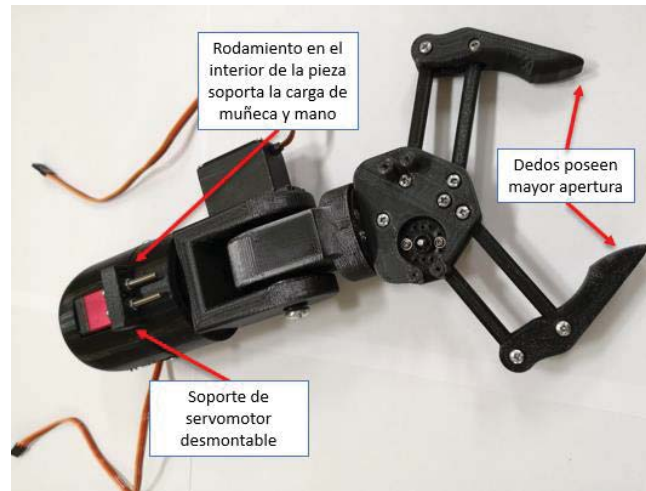
Figura 3-27: a) Mejora en la articulación montando un rodamiento para disminuir carga en el eje de servomotor, b) ensamble de la segunda versión de muñeca y mano
