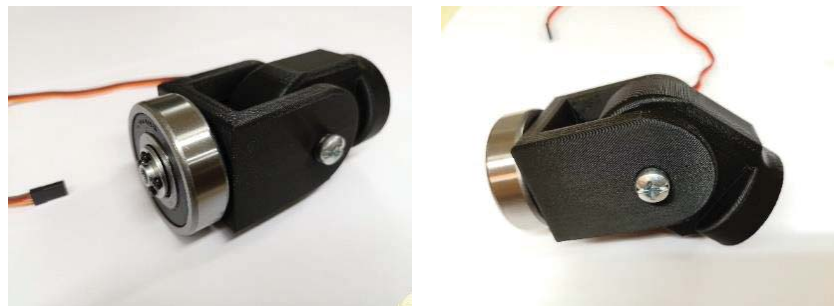
Figura 3-26: a) Mejora en la articulación montando un rodamiento para disminuir carga en el eje de servomotor, b) ensamble de la segunda versión de muñeca y mano
