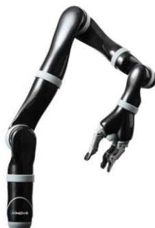
Figura 1-8: Brazo robótico 6 grados de libertad modelo MICO 2 de Kinova (fuente: http://www.kinovarobotics.com )
