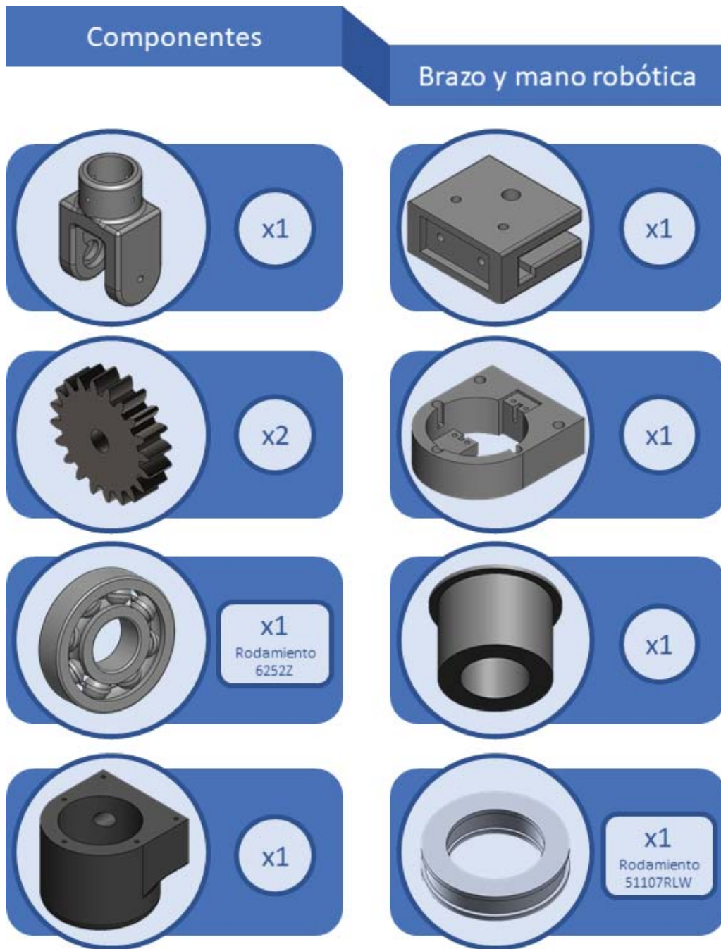
Figura C-3: Componentes de codo y hombro de brazo robótico para manipulación de objetos
