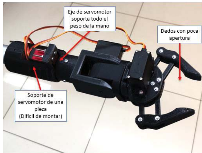
Figura 3-25: Ensamble de muñeca y mano primer diseño
