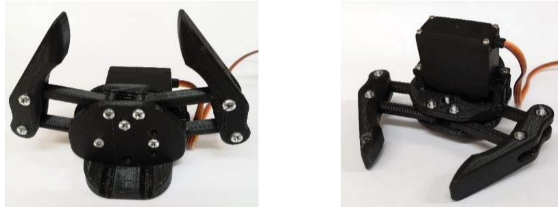
Figura 3-24: Ensamble de primera versión mano robótica
