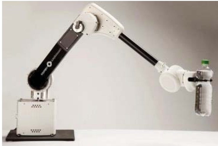
Figura 1-7: Brazo robótico 4 grados de libertad modelo SRA 1000 HD (fuente: http://shop.cpr-roboter.de )
