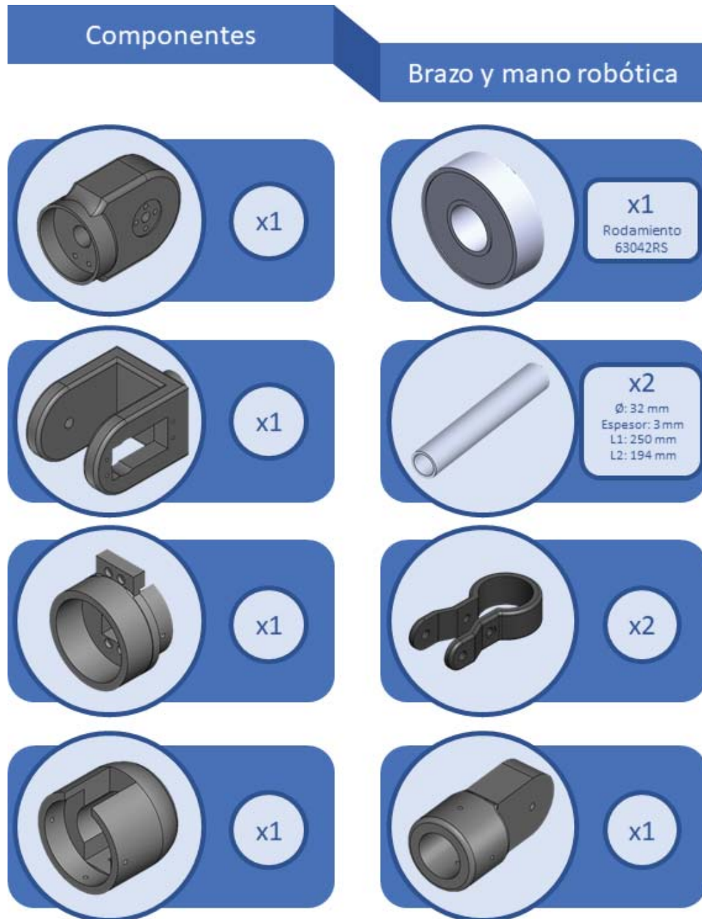
Figura C-2: Componentes de muñeca y codo de brazo robótico para manipulación de objetos
