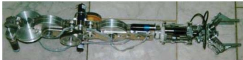
Figura 1-4: Brazo robótico 7 grados de libertad modelo FZI arm [20]
