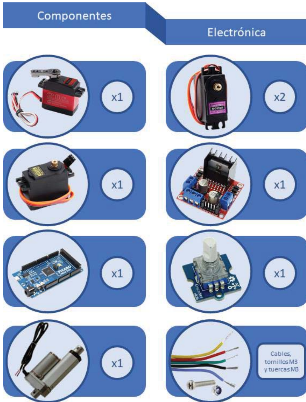
Figura C-4: Componentes electrónicos de Brazo y mano robótica para manipulación de objetos
