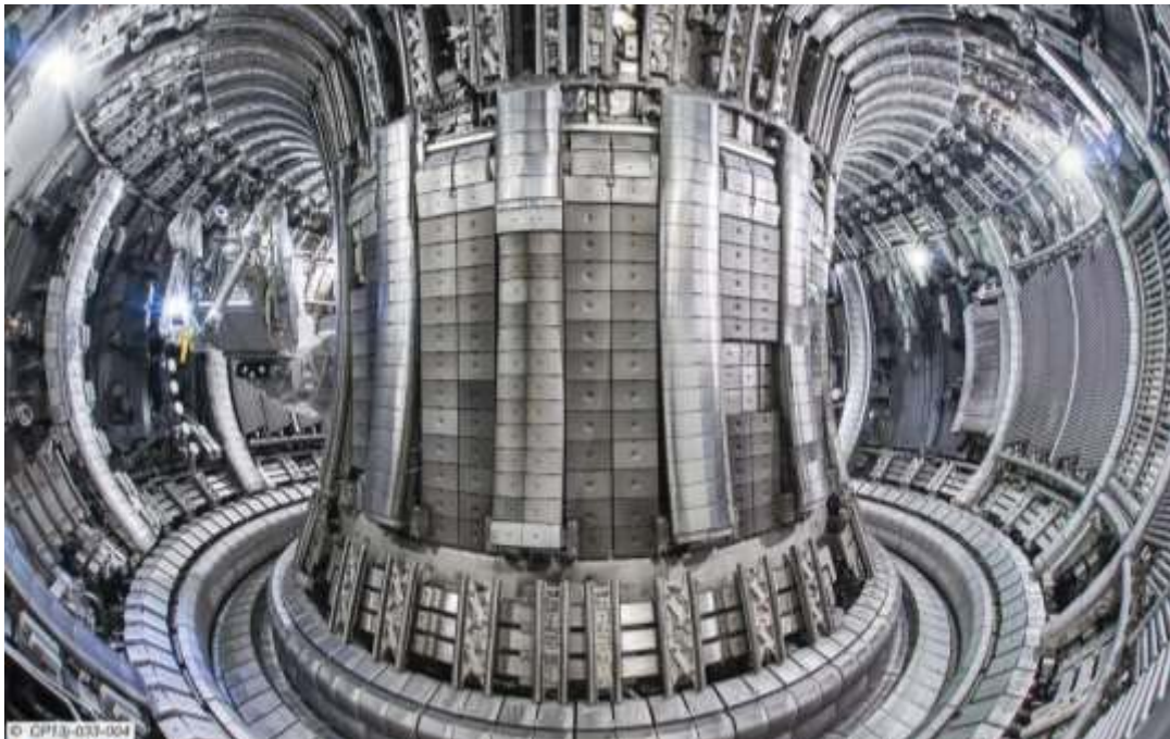
Figura 1-10: Dispositivo Tokamak JET (fuente: https://www.euro-fusion.org )
