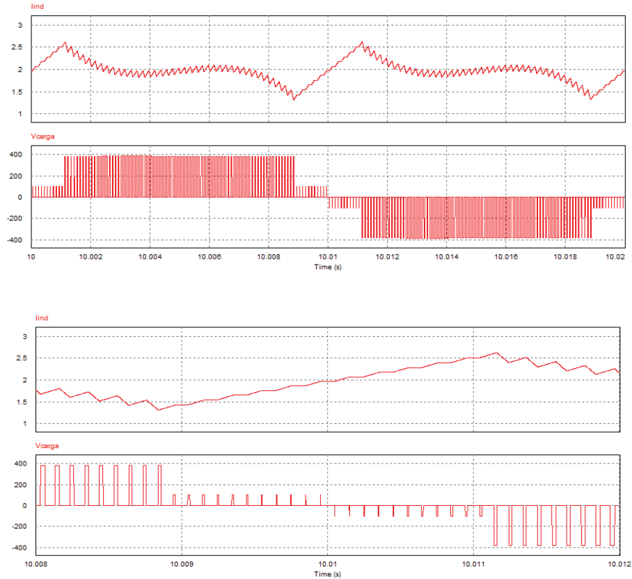
Figura 3-6 Formas de onda de la corriente en el inductor y el voltaje en la carga.
