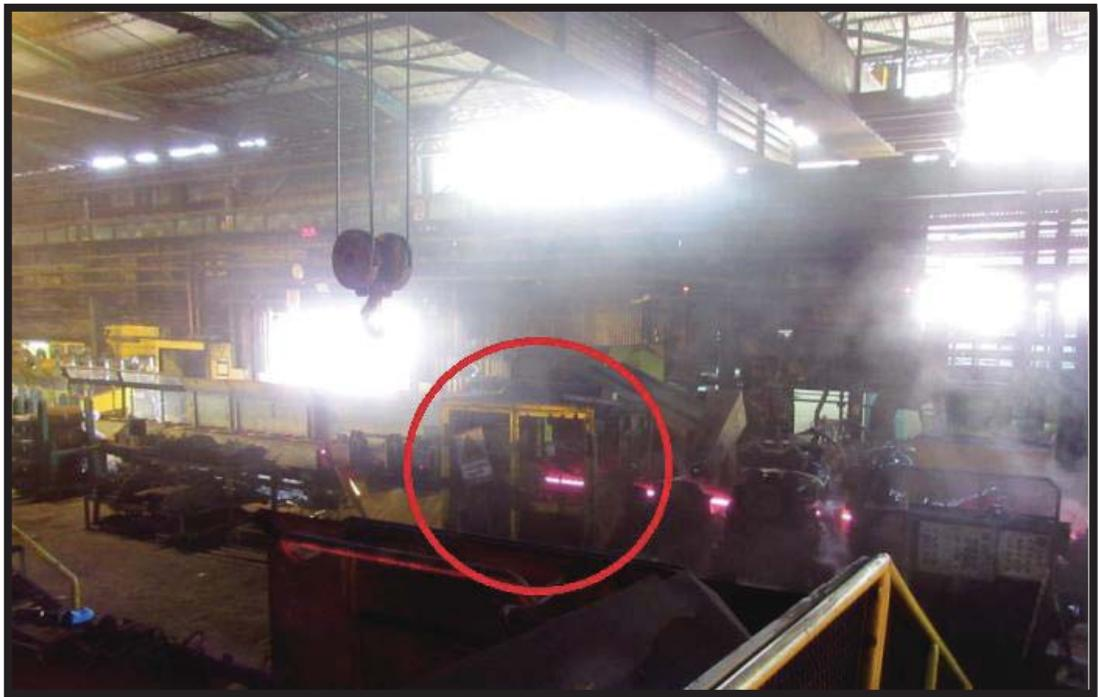
Ilustración 4.5: Mecanismo de Corte
