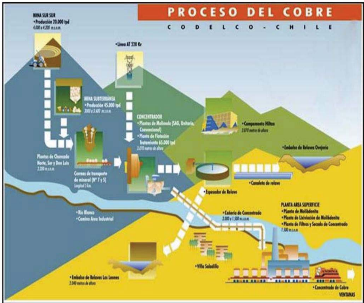
Figura 2. Proceso productivo Codelco División Andina
