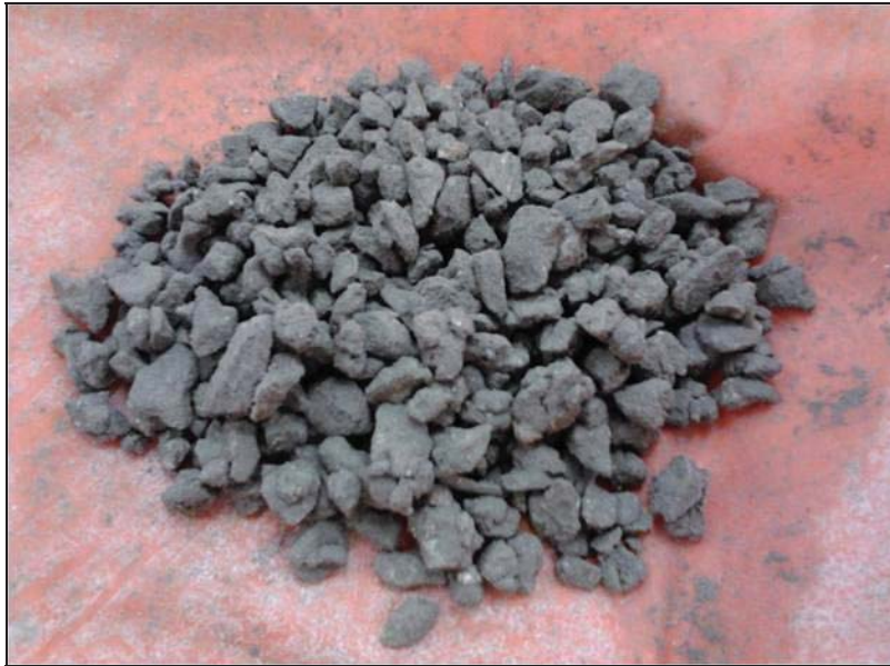
Figura 18: Aglomerado-Curado ácido, 25 [% v/v] de ácido.
