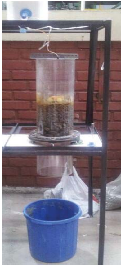
Figura 27: Aparición Color rojizo sobre partículas del mineral, Columna de Lixiviación N°1.
