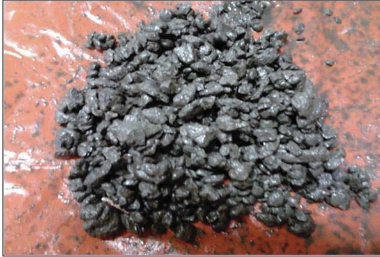
Figura 20: Aglomerado-Curado ácido, 75 [% v/v] de ácido.
