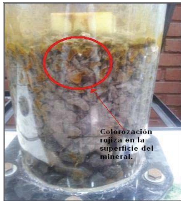
Figura 28: Coloración rojiza partículas de mineral, Columna de Lixiviación 1.
