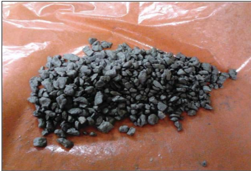
Figura 19: Aglomerado-Curado ácido, 50 [% v/v] de ácido.
