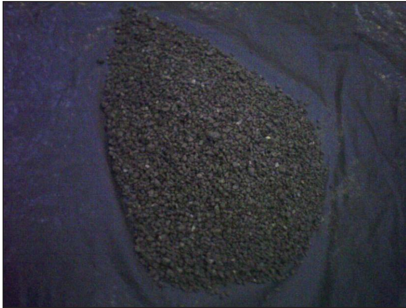
Figura 46: Mineral roleado y aglomerado, proceso de curado ácido.
