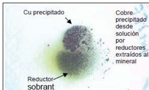
Figura 10: Cobre precipitado a partir de PLS, por reductores del mineral.
