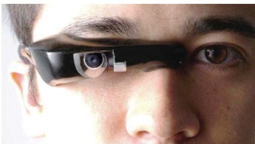
Ilustración 5-2 Dispositivo de visualización montable (HMD)
