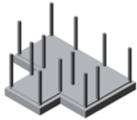
3. Pies derechos, Primer Piso Pilares de perfiles metálicos tipo Metalcón formado por perfiles C.
