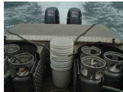
Motores acondicionados para funcionar a gas
