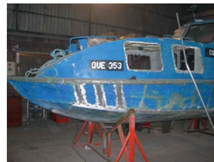
Lancha de aluminio en reparación
