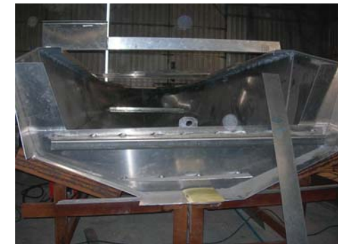
casco con espejo y borde de cubierta
