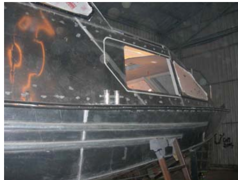
colocación de parabrisas y ventanas
