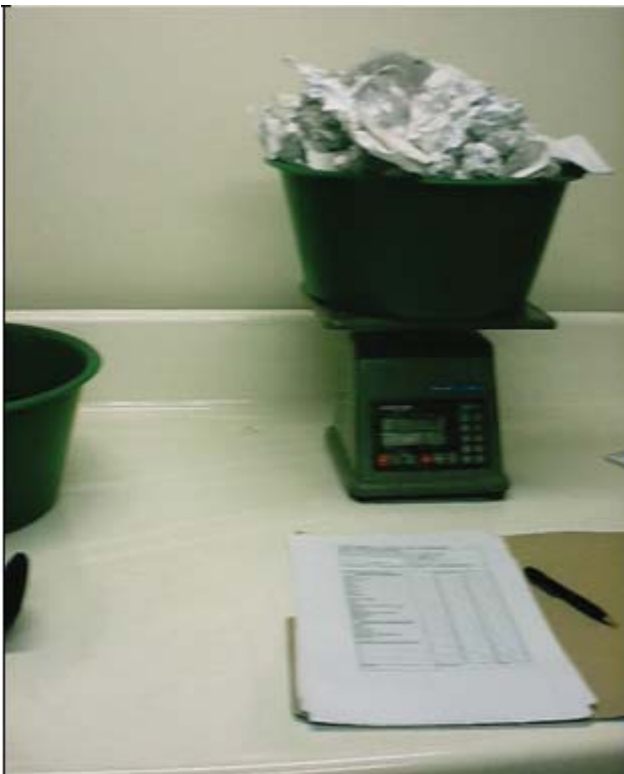
Figura 5.3. Balanza electrónica con recipiente que presenta residuos de papel y planilla de datos.
