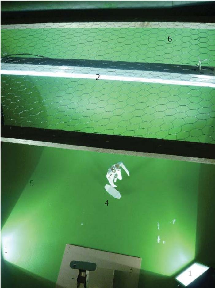
En la imagen superior se puede apreciar dos foco halógeno (1), el tubo fluorescente (2), el atril para la cámara (3), el personaje de cartón (4) y el panel verde (5) y la rejilla superior (6).
