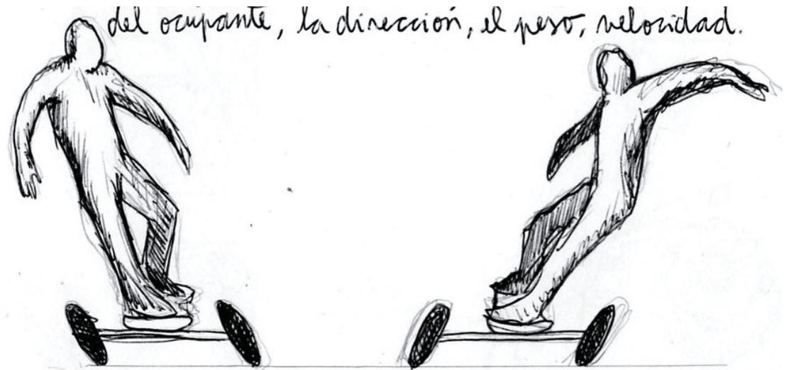
Imágenes que muestran el funcionamiento que tendrían las ruedas delanteras en el momento de maniobrar de un lado hacia el otro, estas se moverían simultáneamente al momento de ejercer presión hacia cierto lado, izquierda o derecha, logrando así un cambio en el recorrido.
