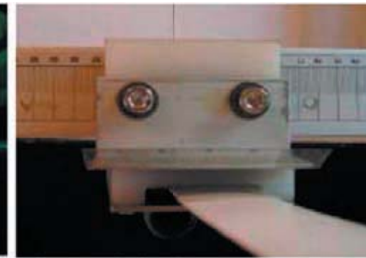
rotula y strut con regla de medición incorporada en milímetros (distancia desde el centro)
