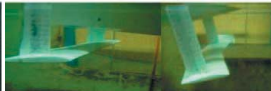
rotula y strut con regla de medición incorporada en milímetros (variación en profundidad)
