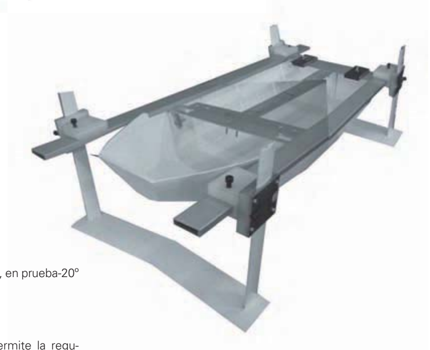
rotula y strut con regla de medición incorporada en milímetros (distancia desde el centro)
