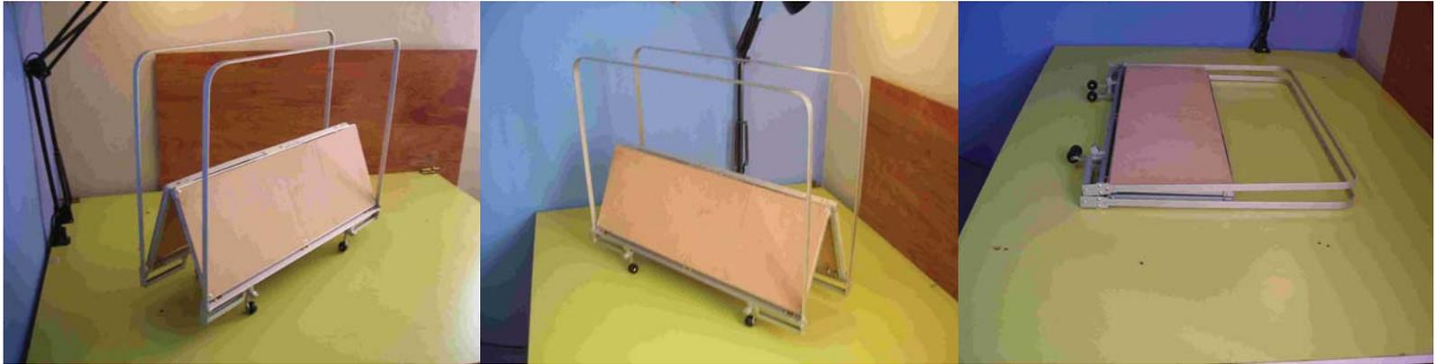
Secuencia de pliegue de maqueta segmento del túnel
