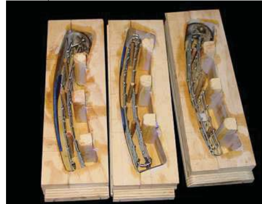
Vacío a rellenar. La matriz se separa en 2 partes diferentes en las cuales se formará la pieza.
