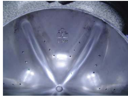
Base del molde: pie, talón y punto de inyección. Inscripción símbolo Pet descripción tipo de plástico
