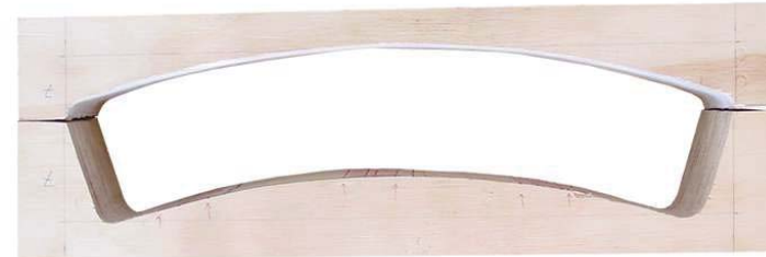
Vacío a rellenar. La matriz se separa en 2 partes diferentes en las cuales se formará la pieza.
