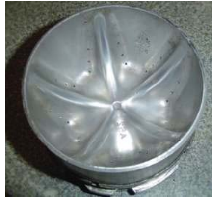
Base del molde: pie, talón y punto de inyección. Inscripción símbolo Pet descripción tipo de plástico
