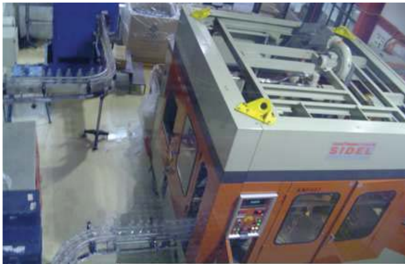
Esta máquina sopla alrededor de 23 botellas por minuto a una temperatura de 153°C
