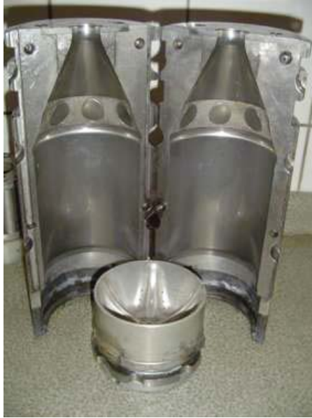
Base del molde: pie, talón y punto de inyección. Inscripción símbolo Pet descripción tipo de plástico
