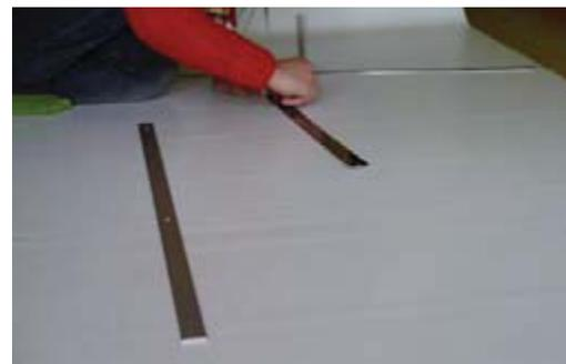
Luego de marcar cada paño, se trazaron las líneas de borde para los cables de acero con una distancia de 4 cm, el traslape para el sellado entre cada paño a una distancia de 2 cm por el tamaño de la selladora y 21 cm para el bolsillo del arco de aluminio.
