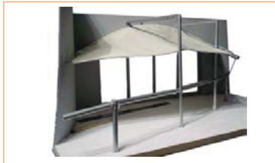
Seis paños lo suficientemente rectos en cuanto a la unión entre ellos, pero con las curvaturas que se requieren para los puntos de fijación y pared.
