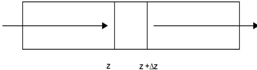
Figura 36: Variación de concentración en el reactor tubular
