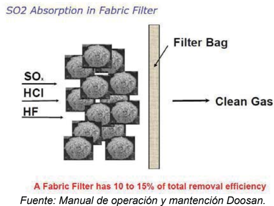
Figura 17. Absorción en filtro de tela
