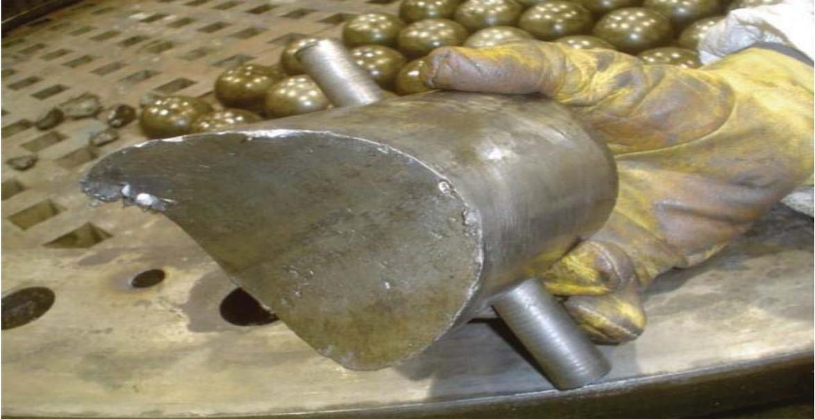
Fig. N° 40: Pasador y tapón de rodamiento, para armado o desarme de rodamiento.
