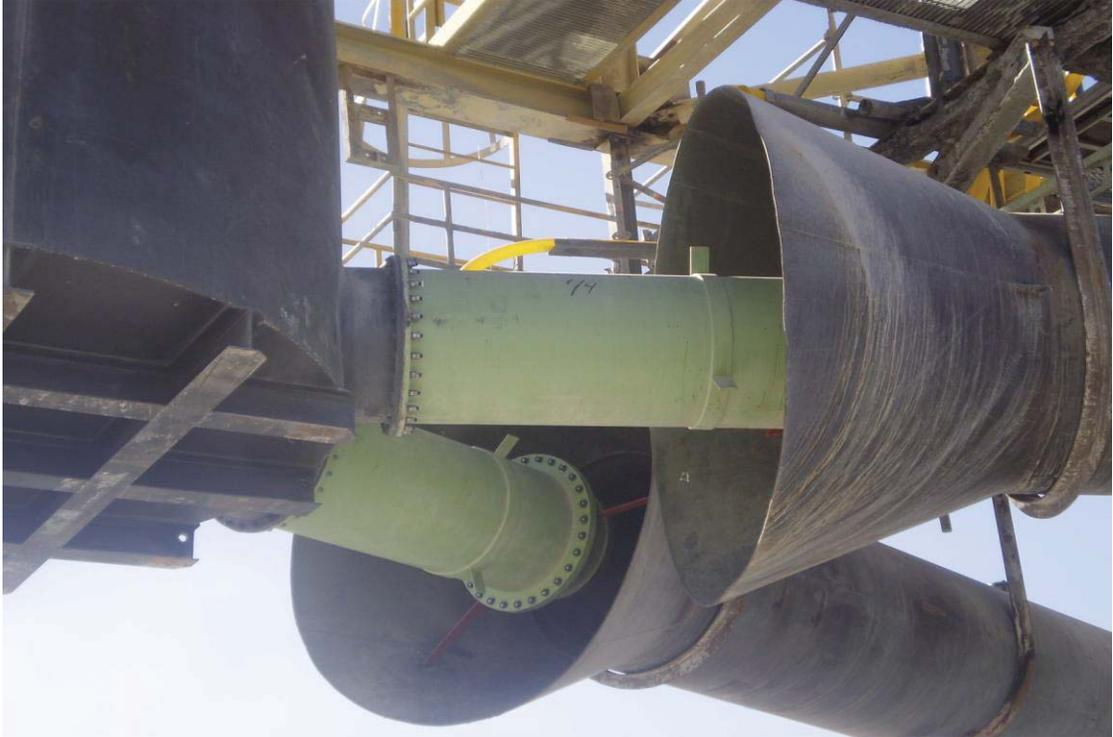
Fig. Nº 46: Cajón de presión, Baquillas de velocidad y Tubos E-Duc Nuevos
