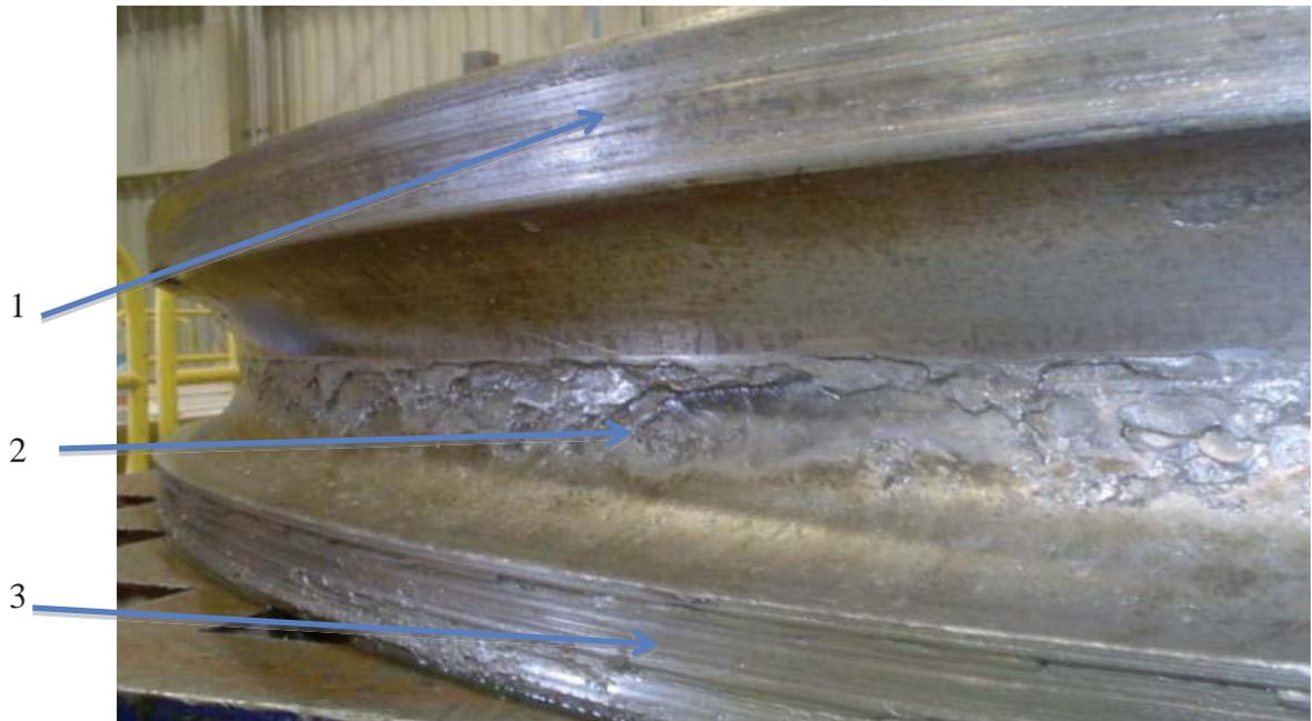
Fig. N° 42: Cubeta interior de rodamiento, daño en borde superior (1), pista de rodadura (2) y borde inferior (3). En mitad de rodamiento que da hacia puente.
