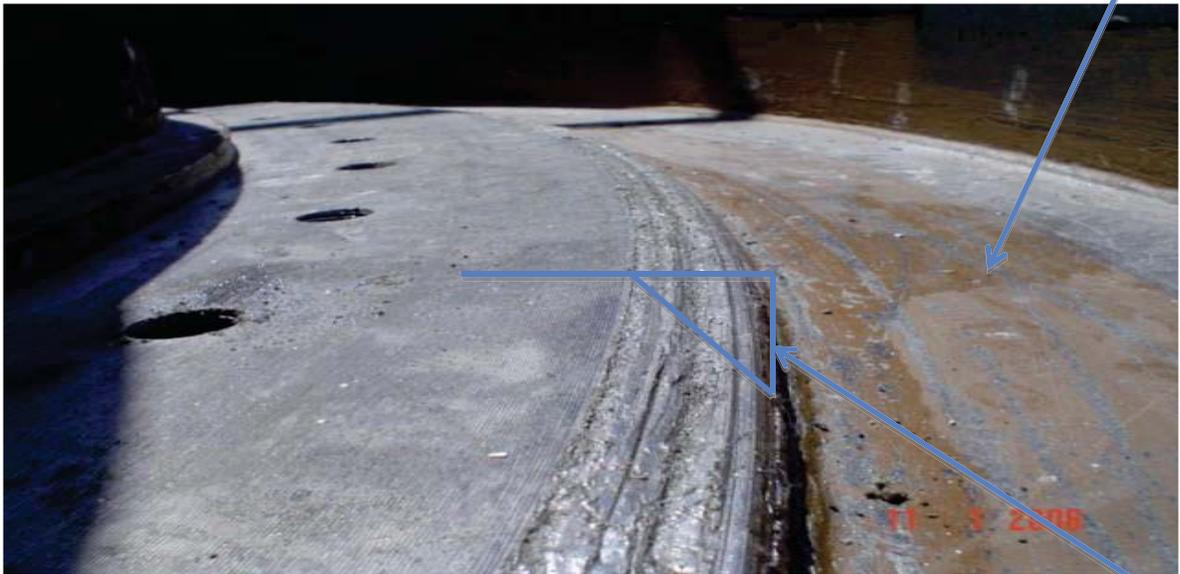
Zona de desgaste en la base de apoyo, producto de roce de la cubeta exterior del rodamiento central. Lo que indica un desplazamiento axial de unos 30 mm.
