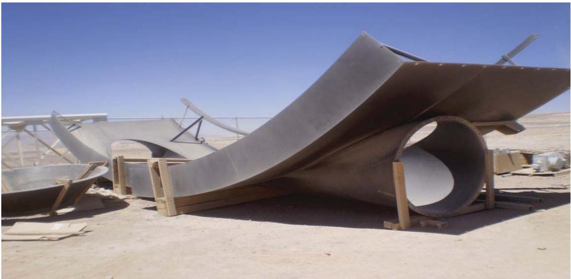
Fig. Nº 47: Sección de Feedwell donde llega tubo E-Duc, almacenada en patio
