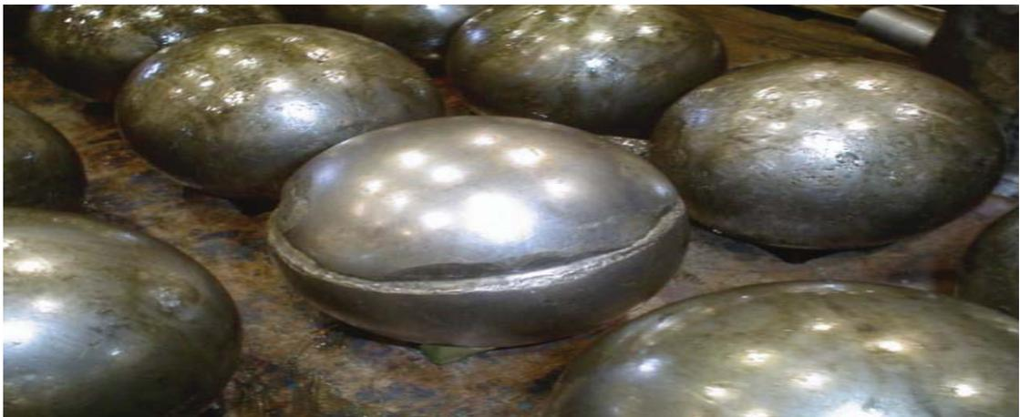
Fig. N° 41: Bolas dañadas del rodamiento, Descamación.
