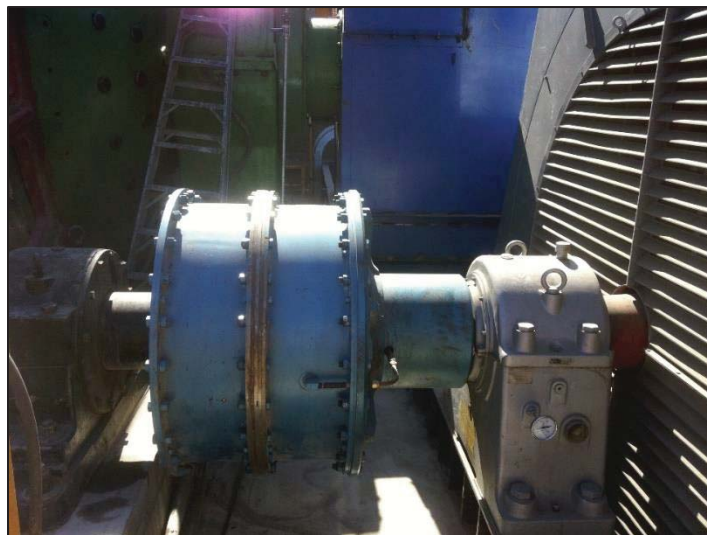
Figura 23: Fotografía Embrague – Fuente: CMCN.
