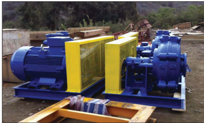
Figura 30: Fotografía Bombas de los Hidrociclones sin Instalar – Fuente: CMCN.
