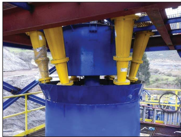
Figura 32: Fotografía Hidrociclones 2 – Fuente: CMCN.
