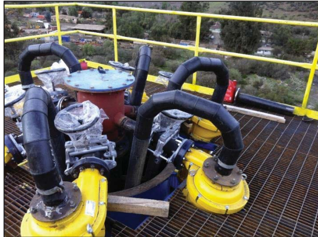
Figura 31: Fotografía Hidrociclones 1 – Fuente: CMCN.
