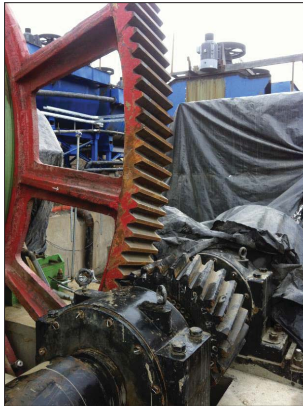
Figura 35: Fotografía Piñón-Corona – Fuente: CMCN.
