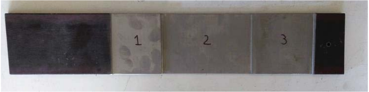
Figura 127: Zonas de desgaste en la viga.
