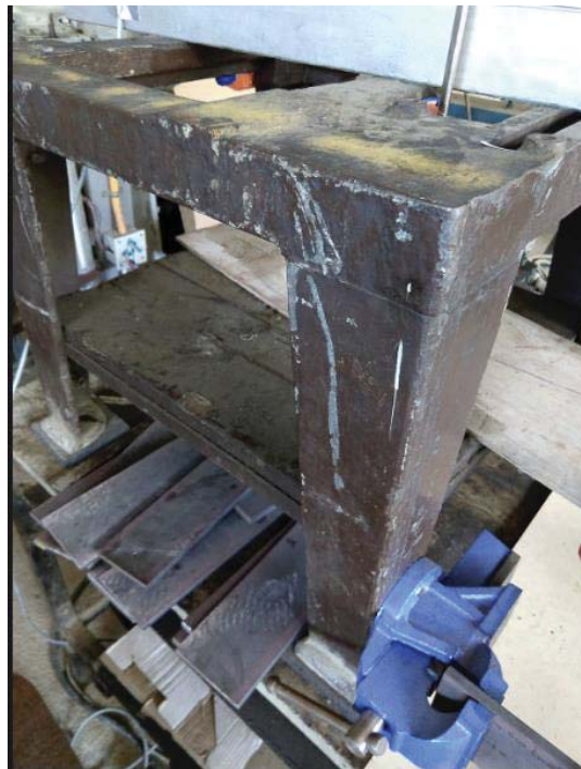
Figura 78: Unión tornillo mecánico a la mesa mediante pernos.
