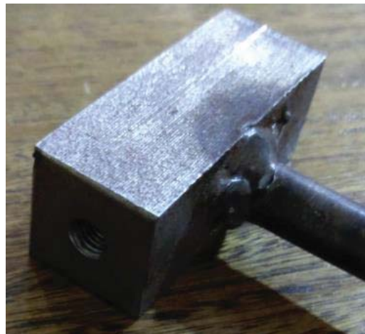
Figura 86: Agujeros roscados para la fijación del transductor.
