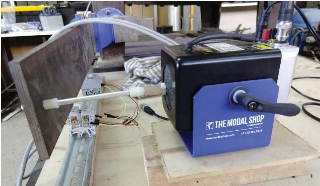
Figura 107: Montaje del shaker y fijación a la viga.
