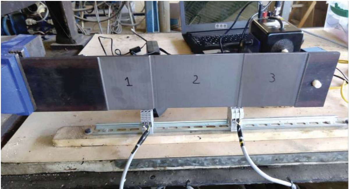
Figura 128: Viga con desgaste, montada en el banco de pruebas.
