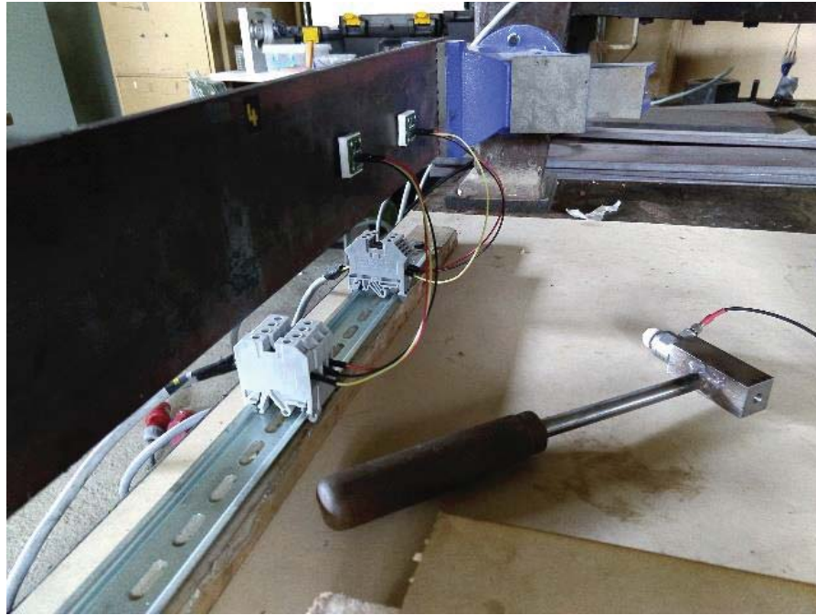
Figura 77: Ubicación de los sensores en la viga.
