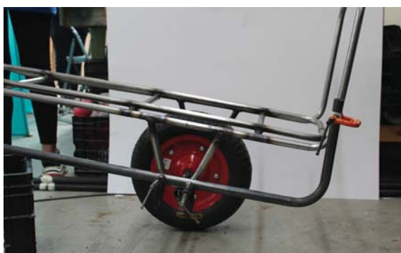
Prueba realizada con el carro 2. Que busca con ese tubo que esta a la altura del eje de la rueda, buscar a cuantos centímetros de la estructura de arriba debe ir para no
