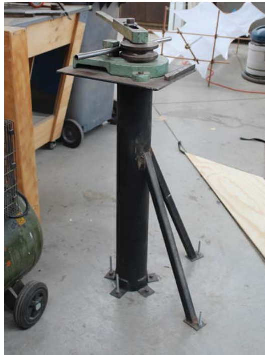
Maquina dobladora de tubos fija al suelo. Segunda imagen muestra el tubo que se utiliza en los ejemplos.
