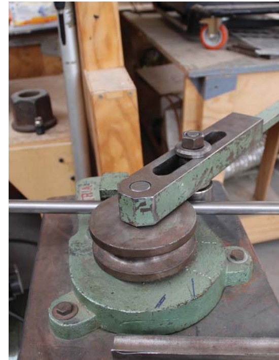
Maquina dobladora de tubos fija al suelo. Segunda imagen muestra el tubo que se utiliza en los ejemplos.
