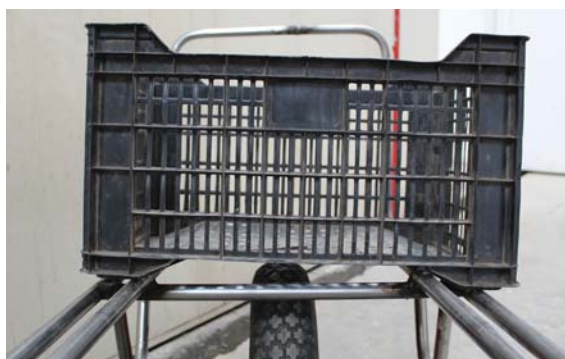
Se puede observar que la caja 2 no calza con las estructuras hechas para la caja 1.
