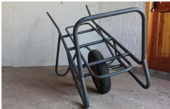
Imágenes que muestran el funcionamiento de las patas auxiliares y la forma en que se apoya el carro al volcarse de lado, diferentes vistas, y como reaccionaría al volcarse de espalda, última foto.
