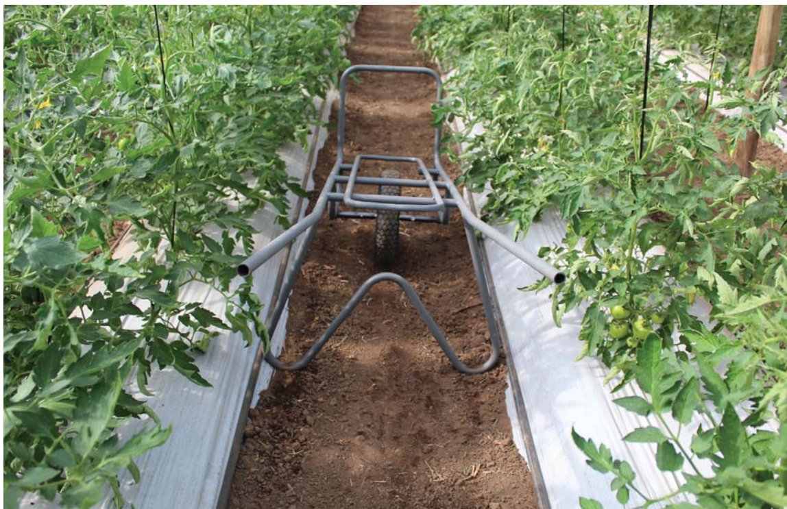
Ancho de patas y mangos que sobrepasa el límite del espacio de trabajo. En la tercera imagen de izquierda a derecha se puede apreciar como en el pasillo de postes se complica mucho más la situación con este ancho sobrepasado.
