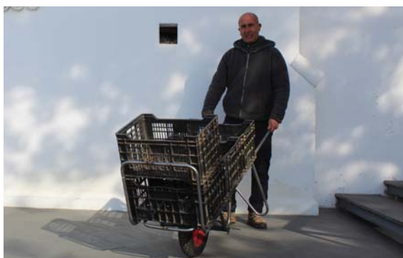
Fotos del carro modificado, donde se muestra con las diferentes cargas que podría tener y posiciones de uso, las últimas dos fotos muestran la inclinación del carro y el sujetamiento que hace posible el riel con las cajas.
